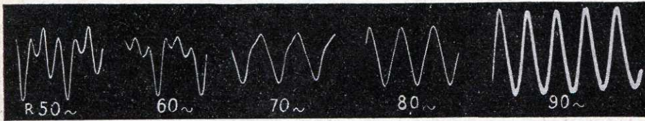
Fig. 14. — Pavillon exponentiel de 1,05 m de long (bouche de 60 cm de côté). L'intensité sonore est élevée, mais la forme ondulatoire est médiocre à 50 et 60 Hz.
