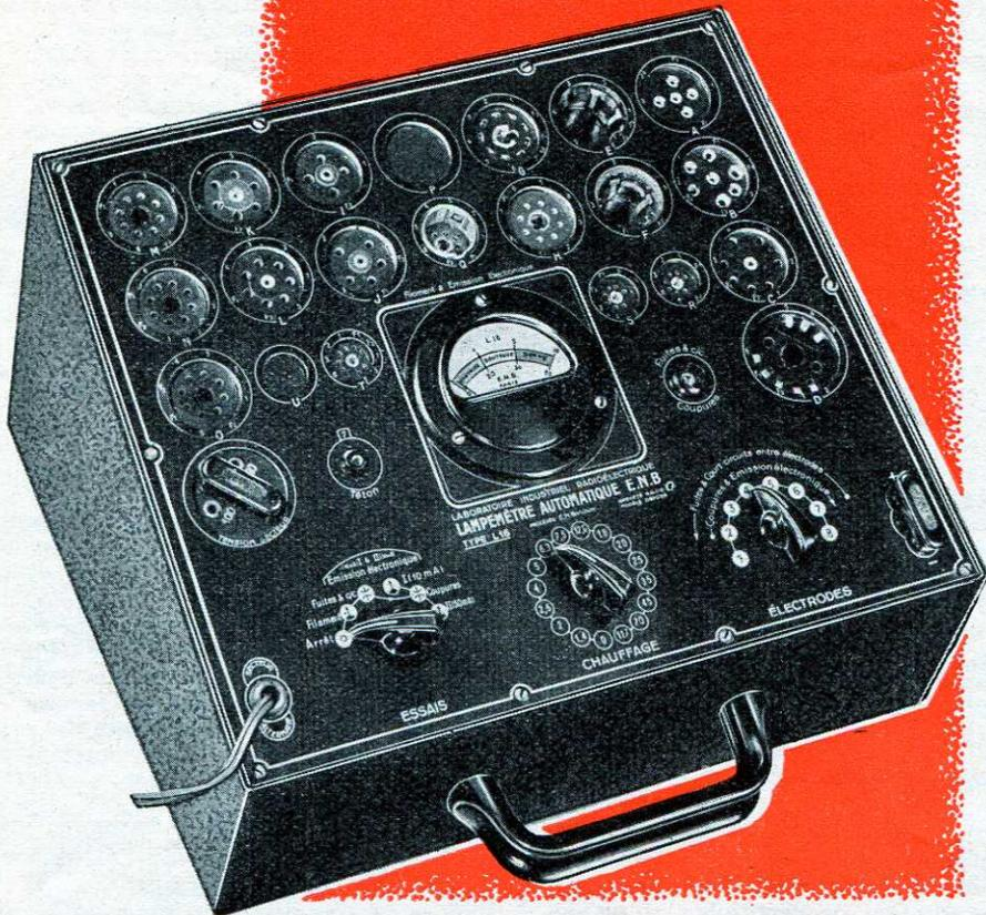
de le filament et la cathode, l'aiguille continue à dévier ou revient incomplètement à zéro, l'importance de la fuite étant proportionnelle à la déviation de l'aiguille.
