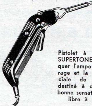
Pistolet à souder de **SUPERTONE**. Remarque l'ampoule d'éclairage et la forme spéciale de l'ensemble destiné à donner une bonne sensation d'équilibre à l'usage.
