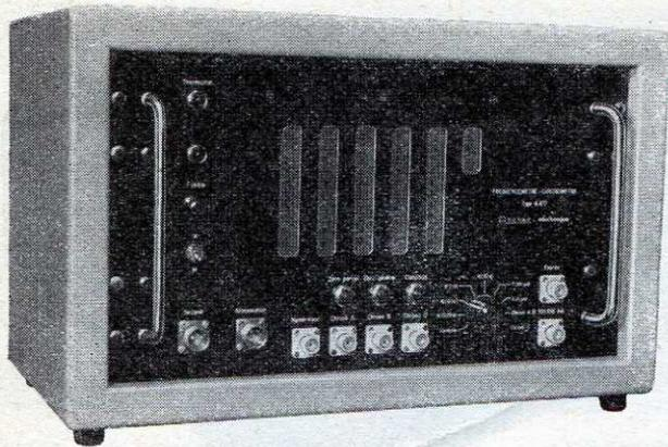
Le fréquences-mètre - chrono-mètre type A 477 de RO-CHAR-ELECTRONIQUE est un compteur à décades et lecture directe par lampes au néon situées derrière les rangées de chiffres.
