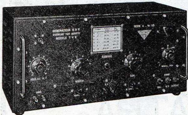
Ce générateur V.H.F. à points fixes a été conçu et réalisé spécialement pour l'étude, la mise au point et le dépannage des récepteurs modernes de Télévision. Associé à un générateur d'images, il fournit, dans les gammes 40 à 225 Mc/s, six canaux de Télévision, image et son, dont les porteuses sont pilotées par quartz.
