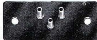
Pour leur raccordement, on utilisera des plaquettes mâles à trois broches de 2,35 mm, dont les dimensions sont  $42 \times 18$  mm, avec des trous de fixation dont l'entraxe est de 32 mm.
