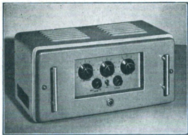
Amplificateur FR 125 de 25 W de sortie (pour 5 mV à l'entrée), dont la distorsion linéaire au maximum de puissance est de 2 0/0 et la courbe va de 80 à 10 000 Hz avec \pm 2 dB. Pourvu de deux correcteurs de tonalité, on peut en extraire aisément le chassis et mesurer les tensions en fonctionnement (réalisation Film et Radio).
