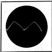
Fig. 12. — En intégrant l'onde rectangulaire, on obtient l'onde triangulaire et desina.
