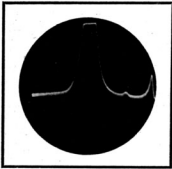
Fig. 14. — La pointe de résonance est aplatie par surcharge de l'amplificateur.
