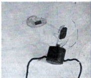
Tube retrouvé au Laboratoire National de Radio-électricité. L'ampoule est brisée, et un morceau de verre avec entrée d'électrode figure à gauche.
