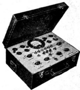
LAMPEMÈTRE 422 Pour contrôle complet de tous les tubes récepteurs radio
