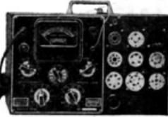
● Tube au néon pour fuites interélectrodes ● Surlutteur, dévoltageur
