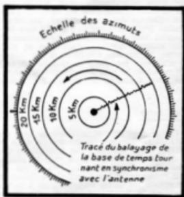
Fig. 3. — Formales de l'image sur l'écran d'un tube P.P.I. auquel sont superposés des échelles de distance et d'azimut.
