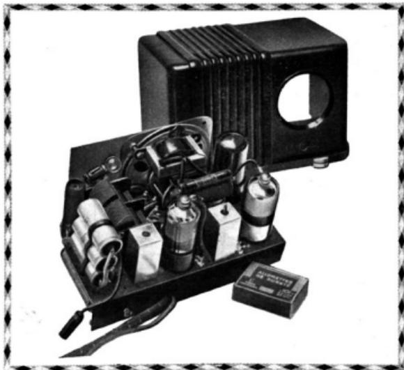
D'abord quelques chiffres : le poste lui-même pèse 1.700 kg, et l'ébénisterie en matière moulée 400 g, soit au total 2.100 kg pour le poste en état de marche.
