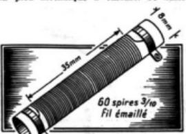
Fig. 4. — Bobine d'arrêt H.F.
