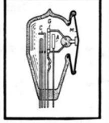
Fig. I. — Le tube électronique microphone. La membrane M module, par effet microphonique, sur la grille G, le courant plaque.
