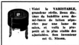
Voici le VARISTABLE, grandeur réelle. Deux diodes de haute qualité avec des mil-lignes de liaison séparées par une ligne de mica, et voilà le plus petit et le plus stable des ajustables. Son inventeur est G. Nissen.
