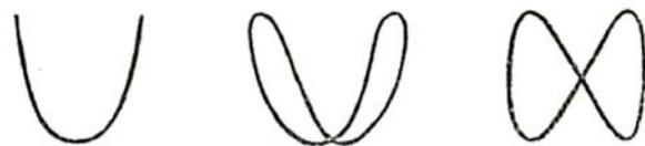
Fig. 6. — Cas où la tension appliquée sur les plaques de déviation verticale a une fréquence double de celle appliquée sur les plaques de déviation horizontale.
