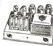
AMPLI META 6F6 PP. A contre réaction AB, 12 w. 2/6J7, 2/6F6, 5Z4. Châs. câblé. 245
