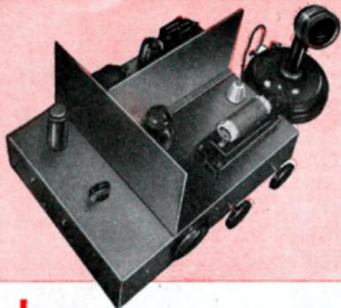
Des blindages séparent l'émetteur en trois compartiments : étage pilote avec quartz (à gauche), étage de puissance (à droite) et modulateur (derrière). L'alimentation est montée sur un châssis séparé.
