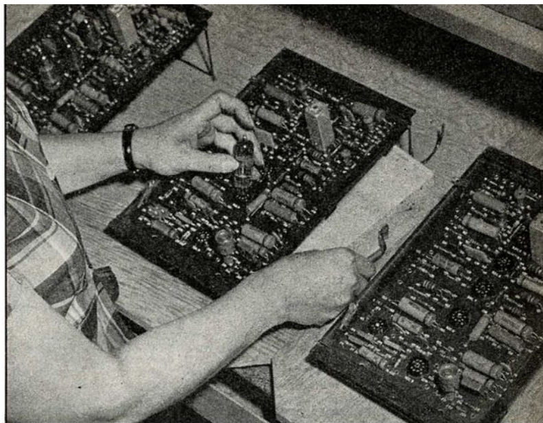
Aux usines WESTINGHOUSE : finition d'une plaquette à circuits imprimés avant l'opération de soudure au trempé.
