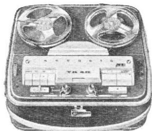
PU/radio et micro. Arrêt automatique en fin de bande. Commande à distance adaptable. Surimpression, play-back avec utilisation d'un préamplificateur. Nettoie-bande escamotable. Réglette incorporée pour collage des bandes. HP 15,5 - 10,5 cm. Puissance 2,5 W. Tonalité réglable. Compteur incorporé. Alternatif 110/220 V, 50 c/s, 58 VA. Valise plastique. H 195 - L 410 - P 380 mm. 12,5 kg. Prix avec micro et bande.
