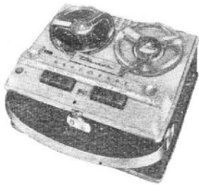
avec remise à zéro. Arrêt automatique par contact bande. Arrêt momentané par touche verrouillable. Entrées : micro 0,3 mV, 6,8 k $\Omega$ , PU 110 mV, 1 M $\Omega$ , radio 5 mV-47 k $\Omega$ . Sortie HPS 4,5  $\Omega$  avec coupure du HP incorporé. Alternatif 110/240 V, 50 c/s, 20 VA. Coffret moulé. H 180 - L 351 - P 290 mm. 9,1 kg. Livré avec micro dynamique, bande, bobine vide et câble PU.
