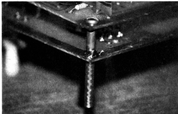
Photo 11. - Gros plan sur le système de fixation des circuits. L'entretoise est enfoncée à force dans le circuit B puis soudée.
