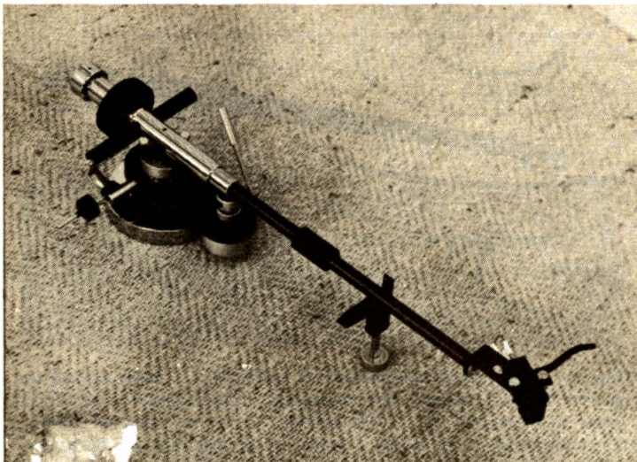
Fig. 3. — Le « Modèle 2 » de l'unipivot de P. Lurné est pratiquement identique au précédent, les quelques différences qui en simplifient légèrement l'assemblage sans influencer sur les performances sont très minimes. Cette fois la plaquette limiteuse d'amplitude est supprimée et l'on aperçoit la barrette supportant la crapaudine. Dans ce cas aussi les fils conducteurs ne sont plus en argent pur, ce qu'apprécie l'élite des « audiophiles » aux « Oreilles d'Or » qui y trouve grande satisfaction esthétique (ni contestable, ni discutable). (Photo Alix - Bagnères-de-Bigorre).
