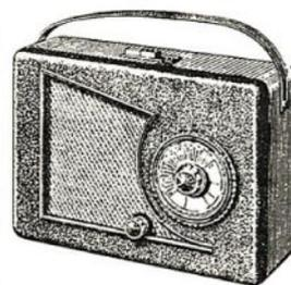
5 transistors + diode au germanium
