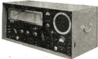
17 tubes ci-dessous décrits : 16F8 1<sup>re</sup> HF - 6K7 2<sup>e</sup> HF - Changement de fréquence par 2 Tubes 6L7 et 6C5. EM 34 indicateur visuel d'accord 2 6K7 1<sup>re</sup> MF - 2 6K7 2<sup>e</sup> MF - 2 6C5 BFO - 6Q7 et 6H6 détectrice et limiteur de parasites - 6C5 pré-basse filtre BF - 6C5 pré BF - 5X4 redresseuse. 6 gammes d'ondes :
