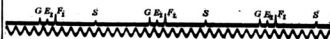
FIG. 5. — Dans cette figure le signal donne lieu à un écho de la région E et un écho de la région F, ainsi qu'un écho de grand retard.
