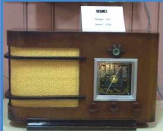
Modèle 547 année 1936 restauré par l'Association Culturelle et Historique de Faches Thumesnil en 2004 Superhétérodyne à 3 lampes plus valve Classe A 04 07 0 0 3 Alimentation : Alternatif 110 à 230 volts OC 20 à 50 m - PO 200 à 570 m - GO 800 à 2000 m
