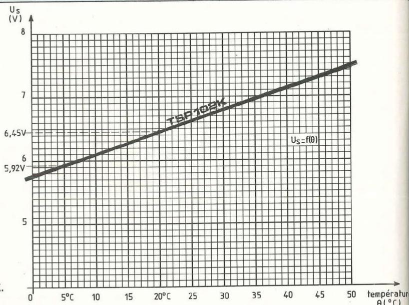
Fig. 4 : Courbe correspondant à un capteur TSP102K.
