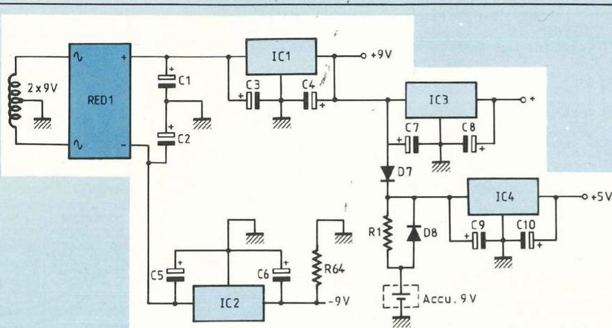
IC4 alimente les mémoires. La résistance R1 est à omettre si on choisit de remplacer l'accumulateur par une simple pile 9 volts.
