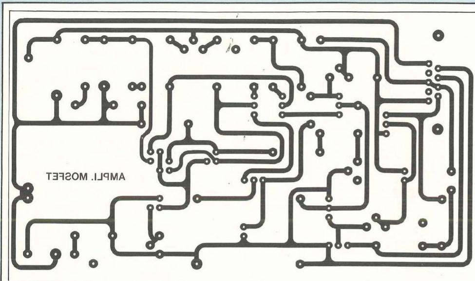
Circuits imprimés de l'amplificateur MOS-FET 2 × 50 watts.
