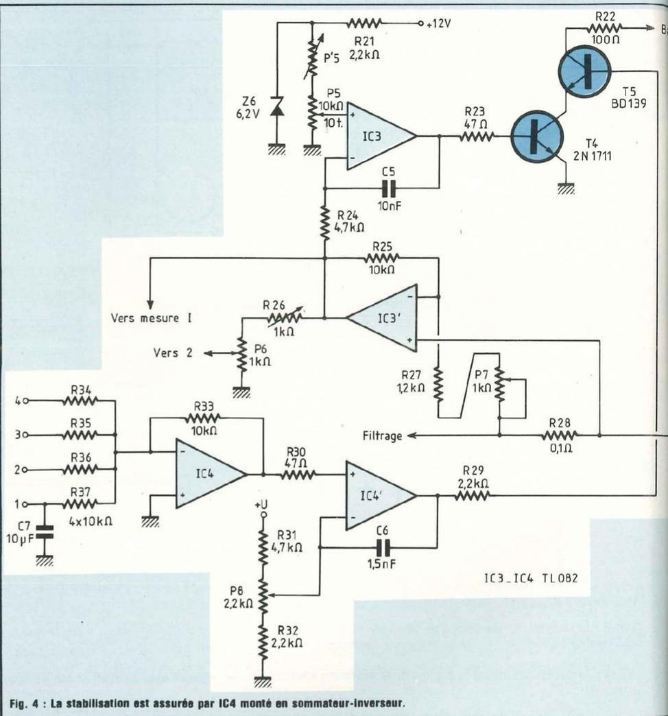
Fig. 4 : La stabilisation est assurée par IC4 monté en sommateur-inverseur.
