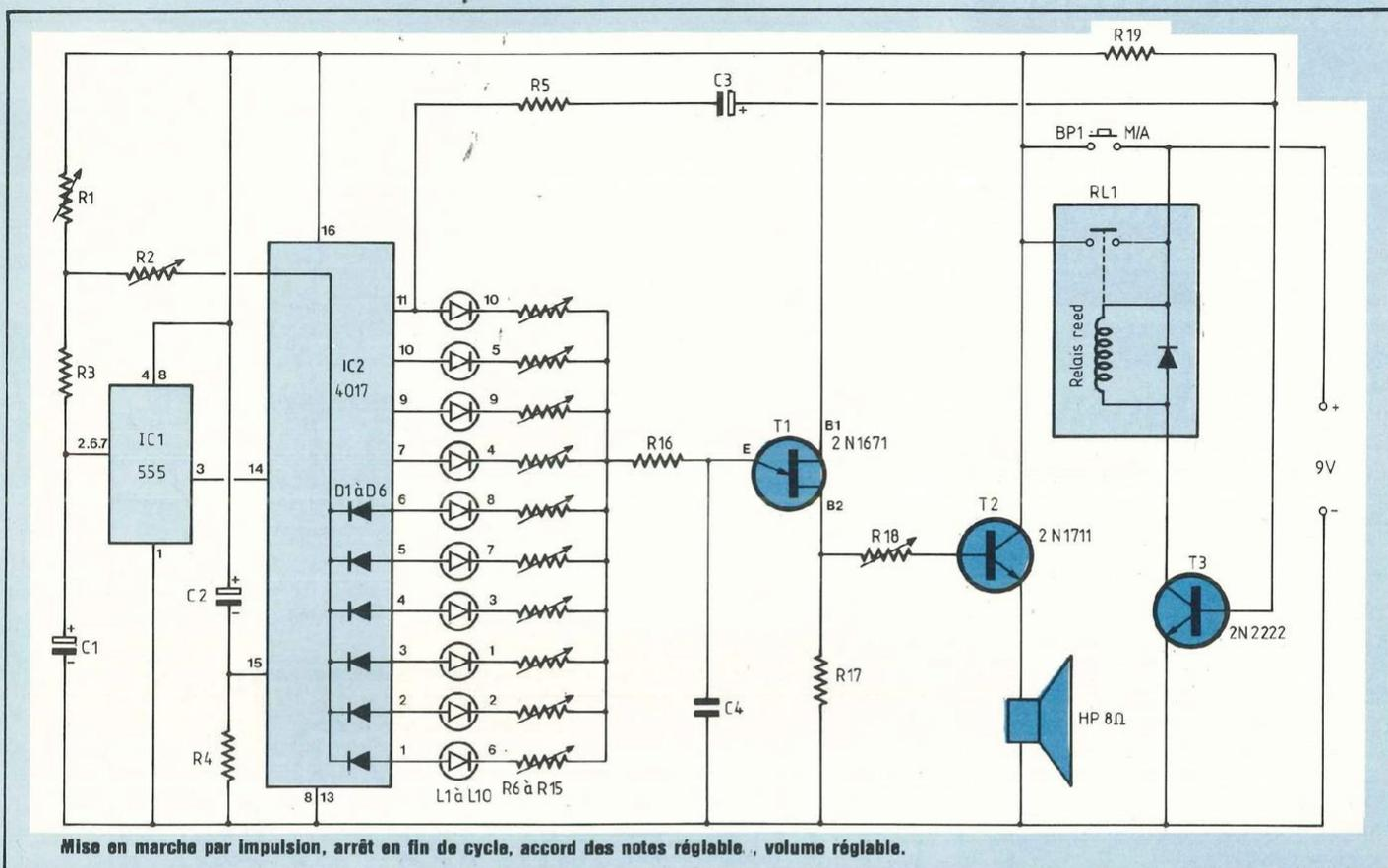
Mise en marche par impulsion, arrêt en fin de cycle, accord des notes réglable, volume réglable.
