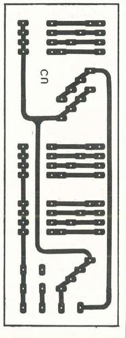
Circuits imprimés de la boîte à rythmes programmables. Le circuit principal devra être gravé avec beaucoup de soin vu la finesse des pistes. Avant d'entreprendre le câblage, vérifier qu'il n'y a pas de coupure dans les liaisons.
