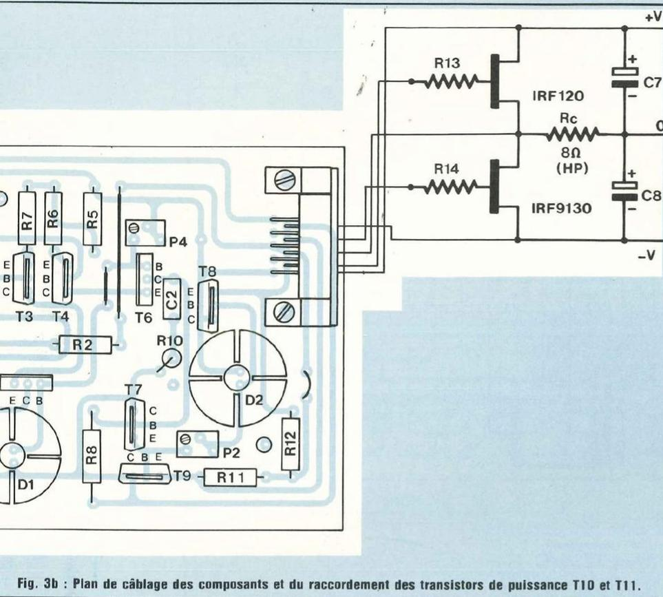
Fig. 3b : Plan de câblage des composants et du raccordement des transistors de puissance T10 et T11.
