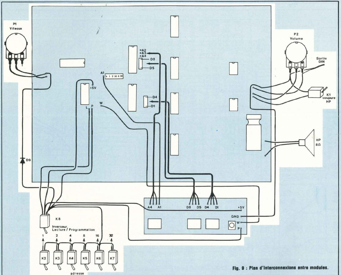
Fig. 9 : Plan d'interconnexions entre modules.
