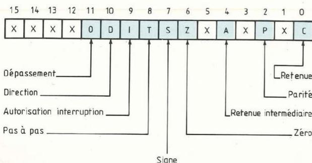
Fig. 7 : Registre d'état signification des différents bits.
