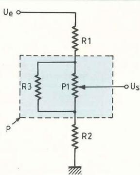
Fig. 8 Elément standard P1 sur lequel est connectée une résistance en parallèle.
