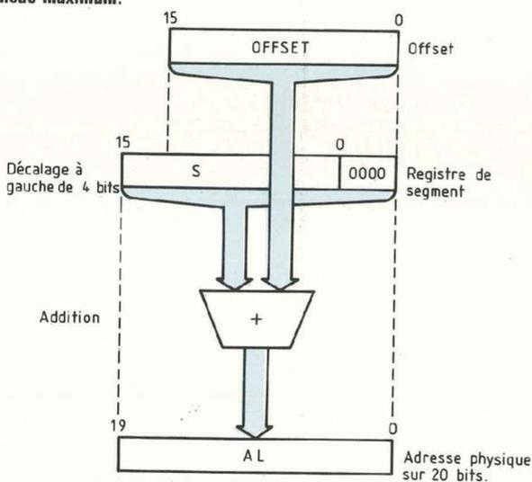
Fig. 8 : Principe de la segmentation.
