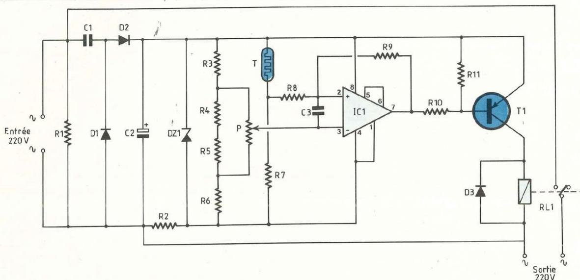
Fig.16 Schéma électrique complet du thermostat de précision. La capacité C3 protège le circuit contre les parasites externes de commutation sur les lignes d'alimentation.
