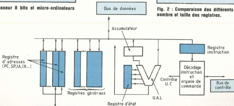
Fig. 3 : Architecture d'un microprocesseur 8 bits classique.
