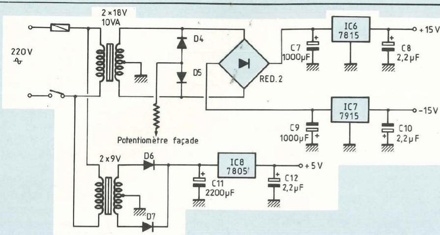
Fig. 6 : Alimentations auxiliaires. Le + 5 V est réservé pour les voltmètres de façade.
