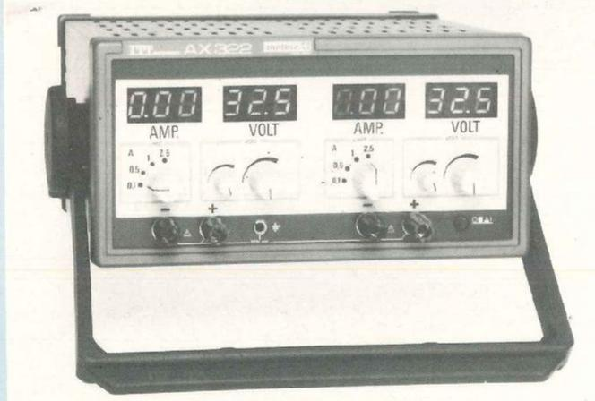
quatre valeurs commutables : 100 mA - 500 mA ; 1 A et 2,5 A. Par ailleurs, les sorties sont protégées contre les court-circuits par un système électronique. Les deux sorties de l'AX 322 peuvent être branchées :
