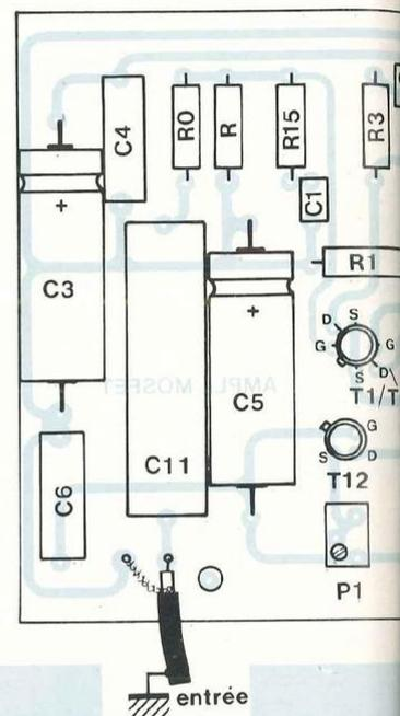
Fig. 3a : Circuit imprimé de l'amplificateur MOSFET.
