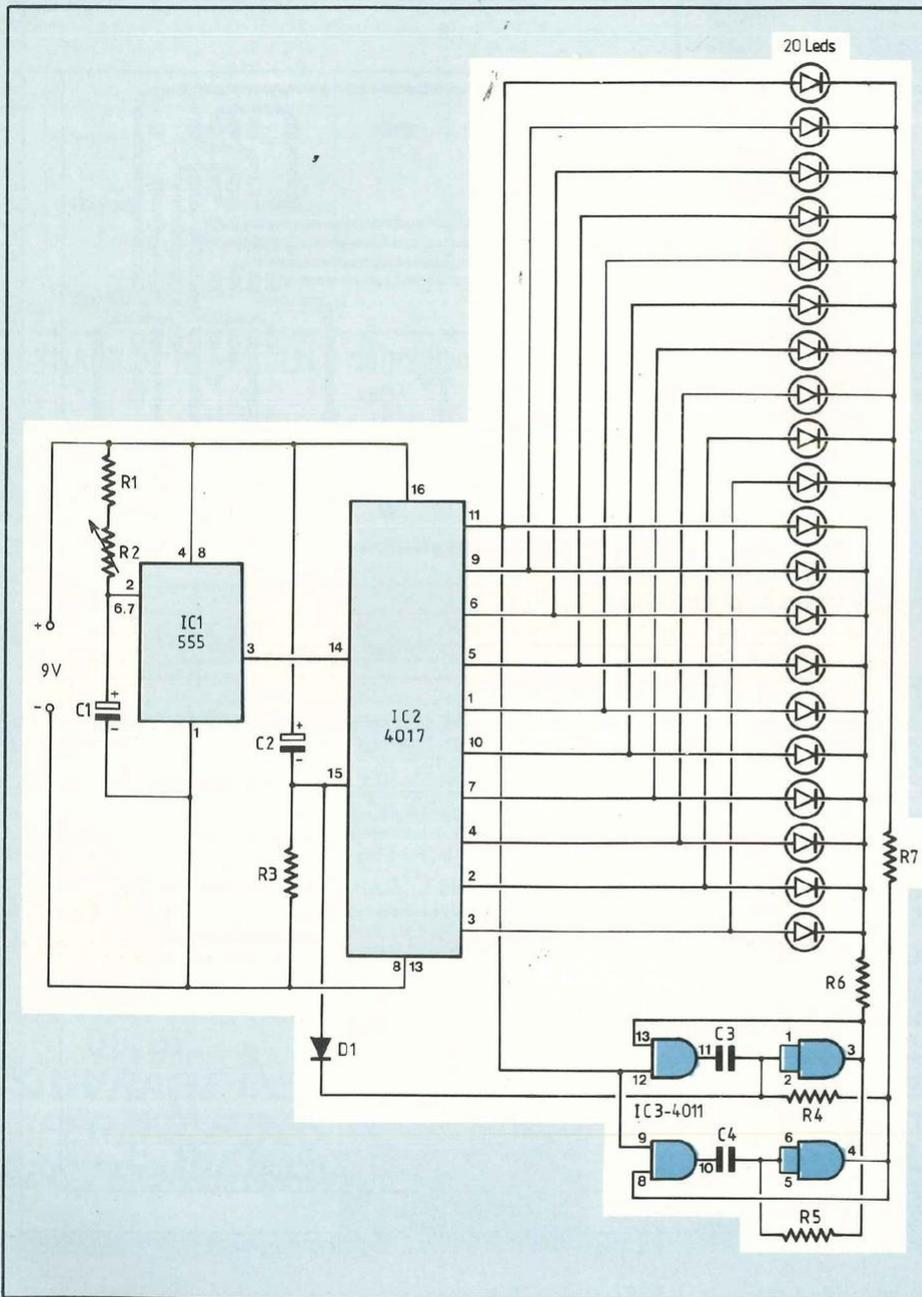
Le principe de ce chenillard est basé sur un inverseur à bascule commandé par impulsions qui alimente deux rangées de dix leds montées à la suite les unes des autres.
