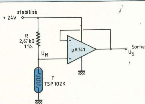
Fig. 3 : Montage à réaliser pour le relevé de la courbe  $U_S = f(\theta^\circ \text{C})$ .
