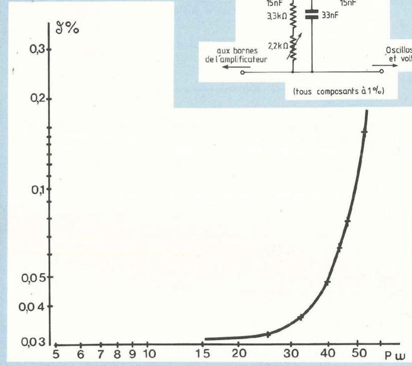
Fig. 6 : Filtre en double T centré à 1 kHz pour apprécier la distortion.
