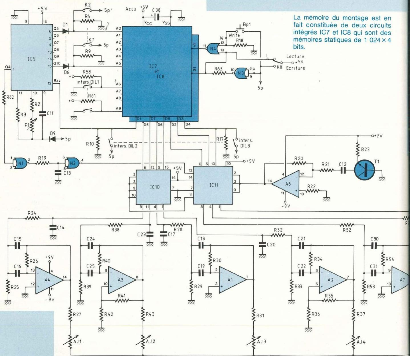
La mémoire du montage est en fait constituée de deux circuits intégrés IC7 et IC8 qui sont des mémoires statiques de 1 024 x 4 bits.
