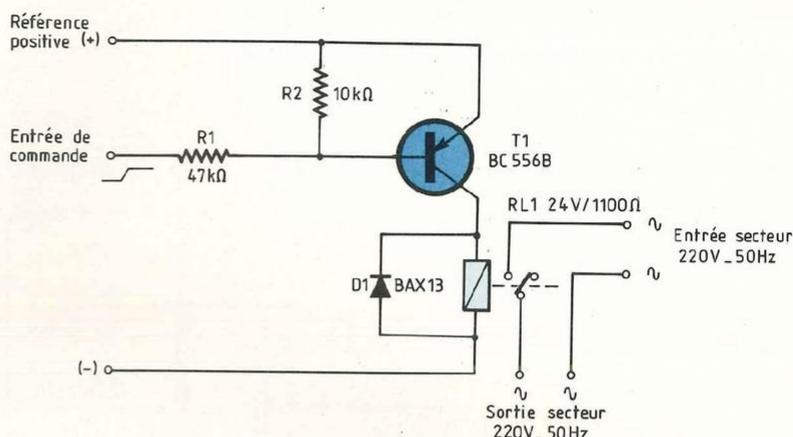
Fig. 15 Circuit de sortie. Il s'agit d'une simple interface de commutation à un transistor.
