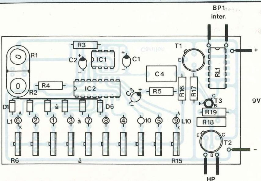
Les cathodes des six diodes sont reliées entre elles côté composants, seule la cathode D1 est soudée côté pistes.
