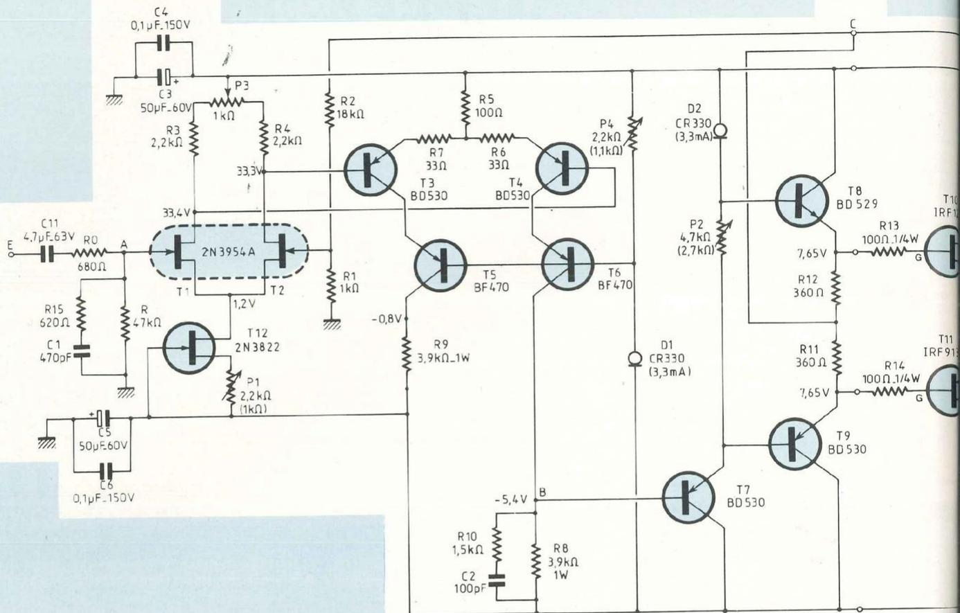
Fig. 1 : Schéma de principe de l'amplificateur MOSFET.
