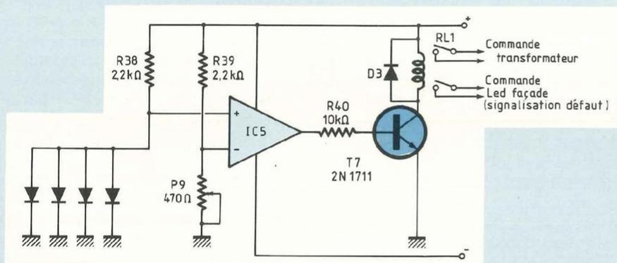
Fig. 5 : La protection thermique est assurée par IC5 monté en comparateur et par les jonctions BE de transistors BD 139 vissés sur les radiateurs à surveiller.
