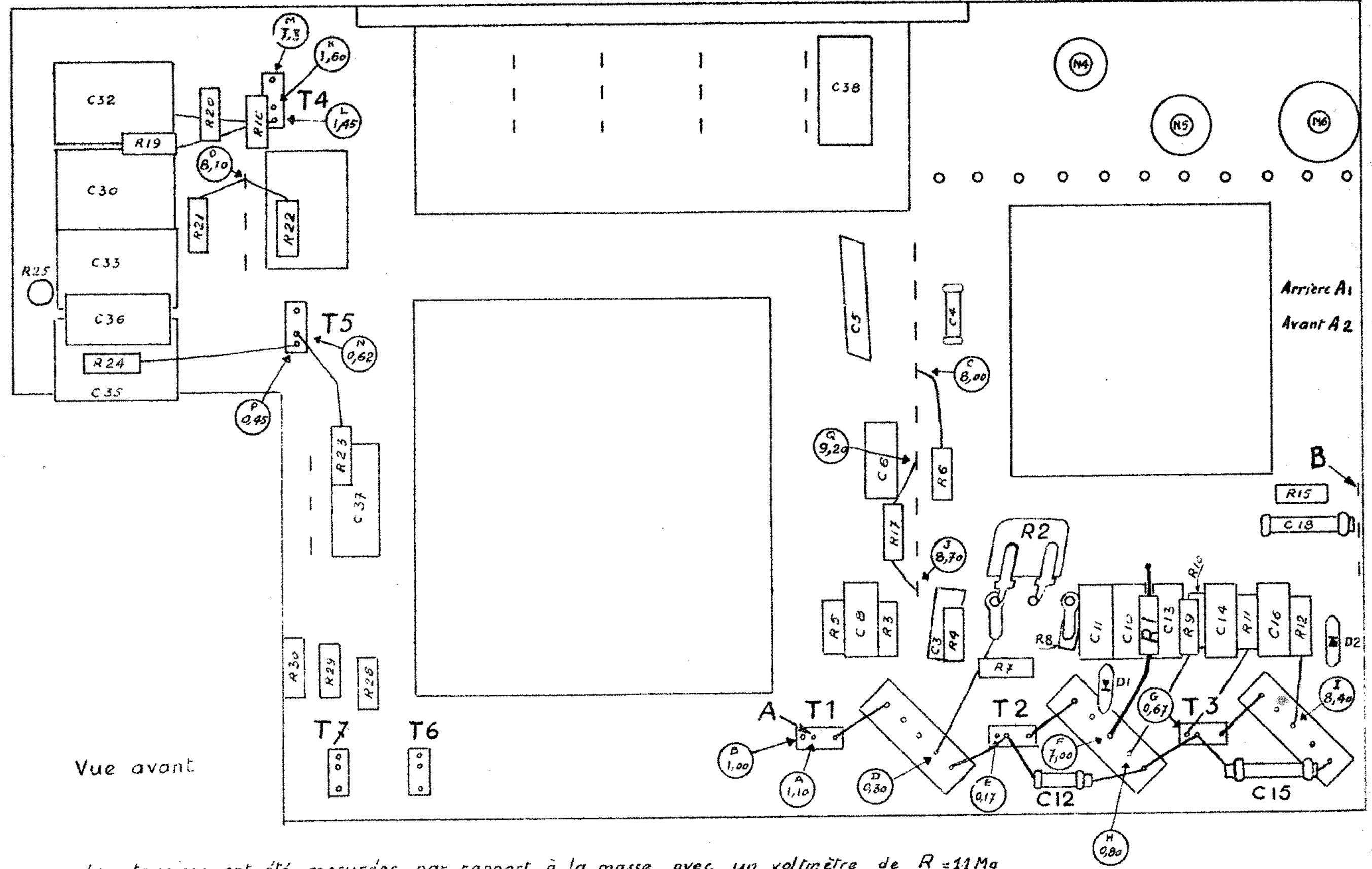
Les tensions ont été mesurées par ropport à la masse avec un voltmêtre de R=11Mg
