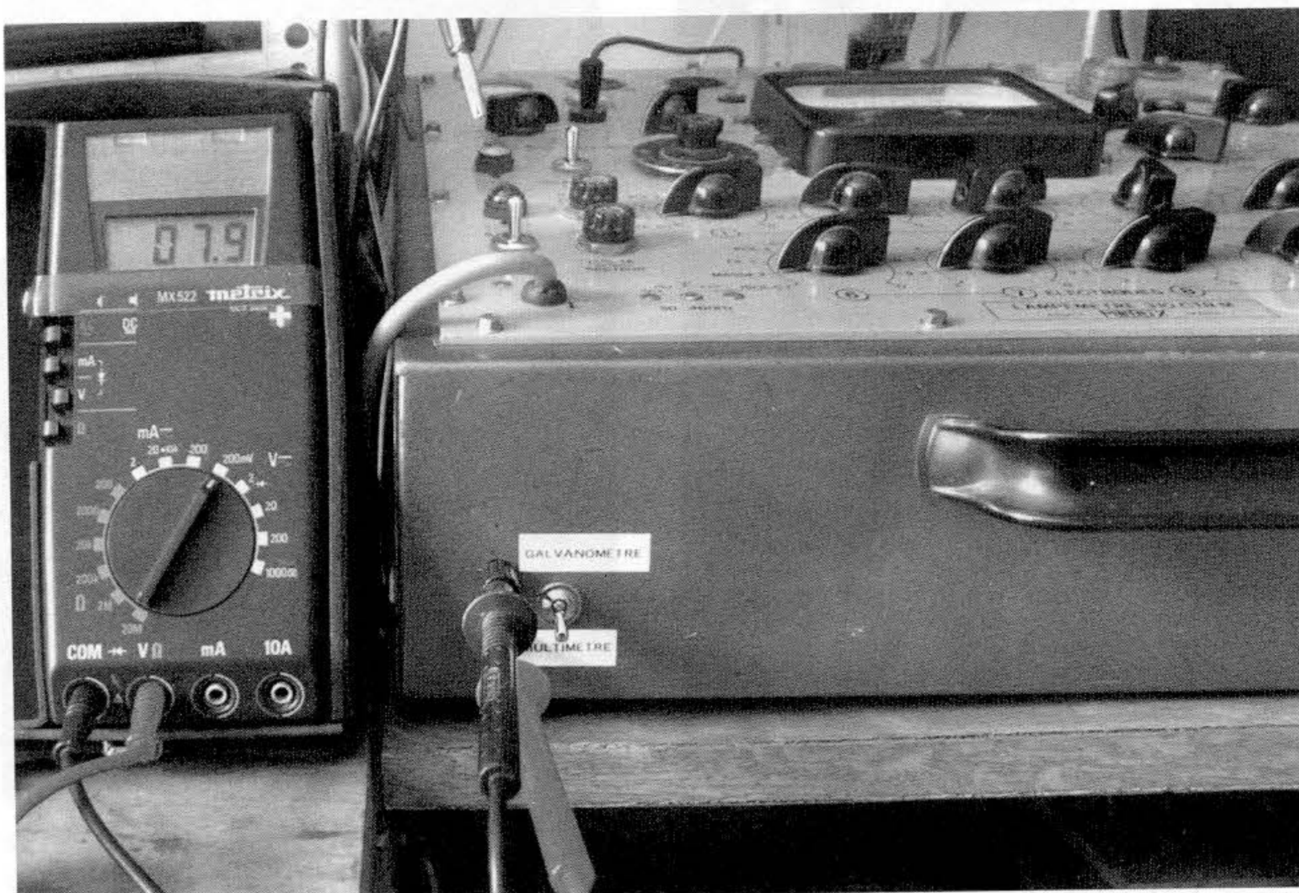
Figures 11 et 12. — Le galvanomètre et le multimètre de contrôle indiquent la même valeur.
