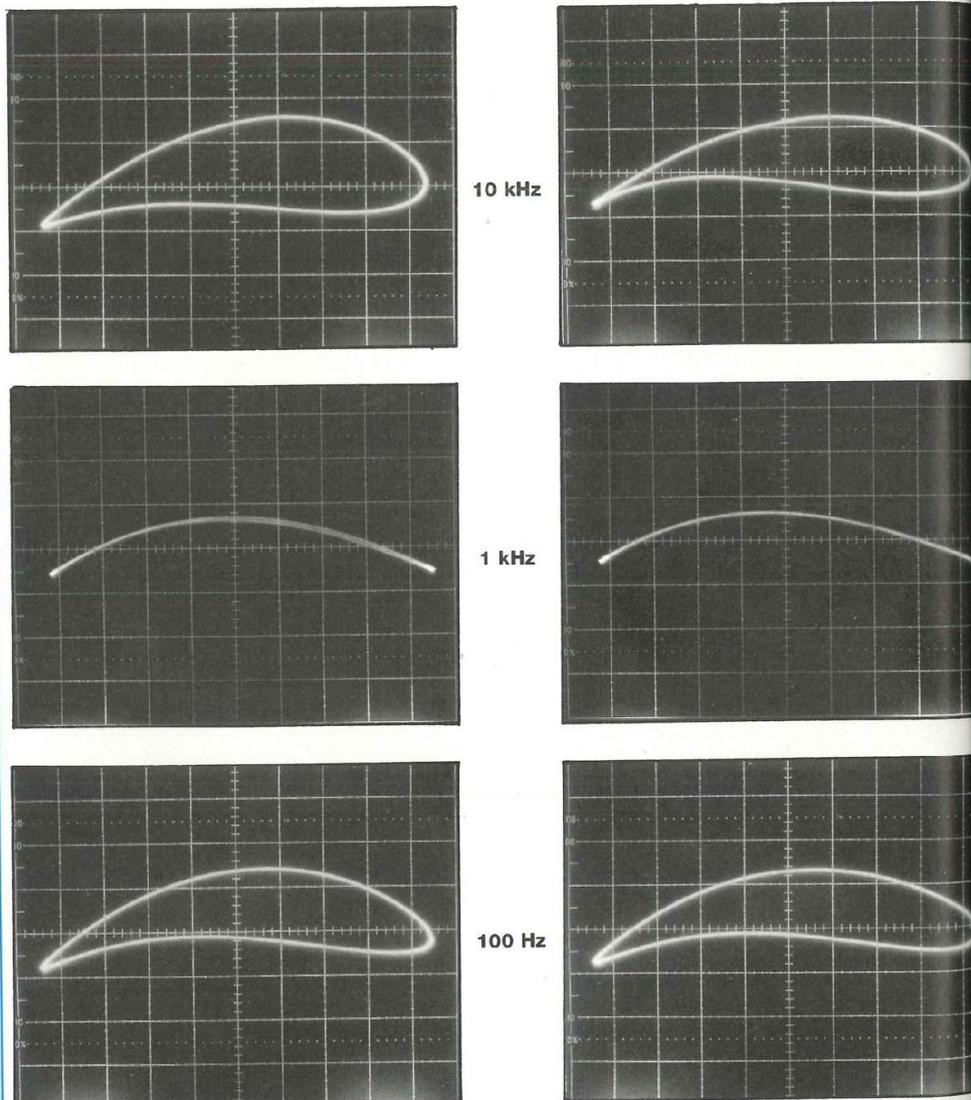
Fig. 4 : La distorsion absolue pour  $V_{out} = 3V$  (à gauche avec l'atténuateur, à droite avec le filtre) visualisée en figures de Lissajous pour trois fréquences.
