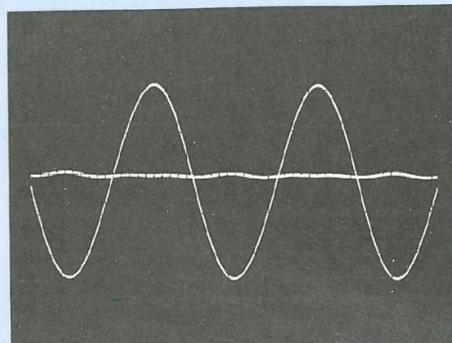
1 - Signal sinusoïdal à 1 kHz.
