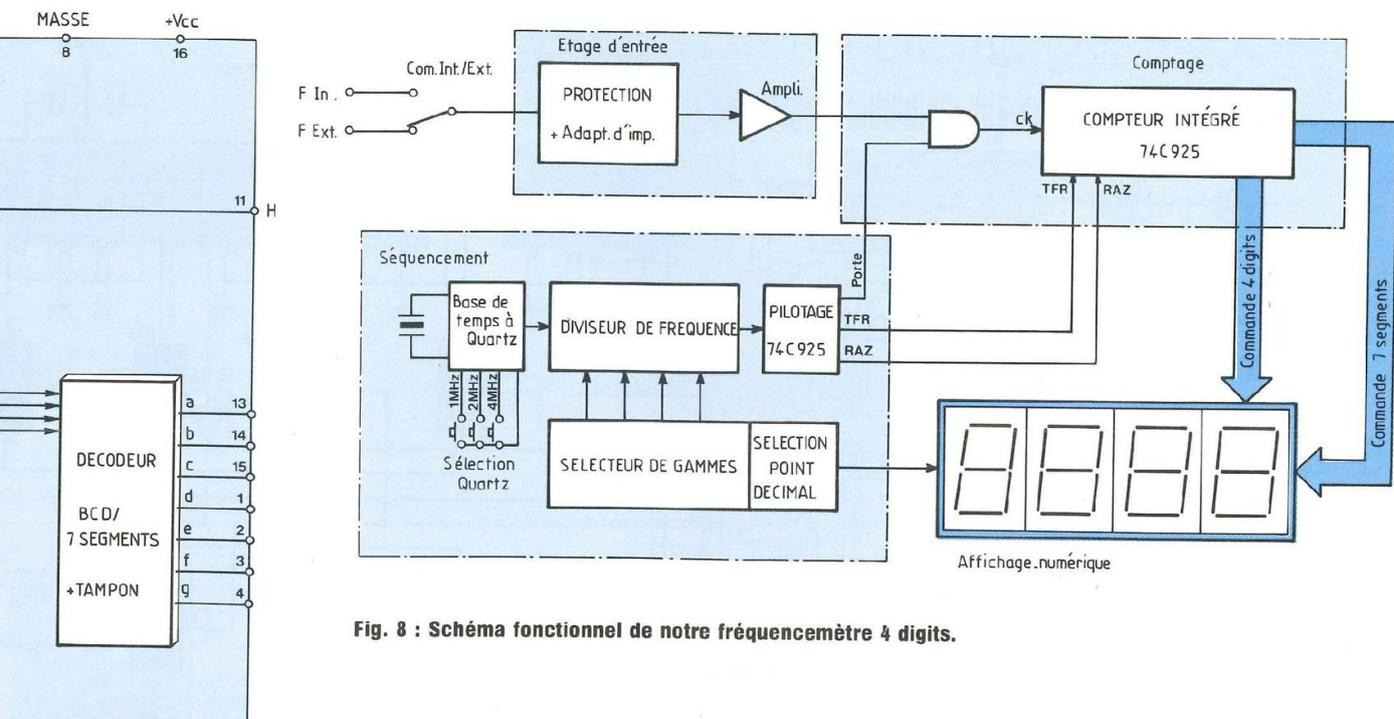
Fig. 8 : Schéma fonctionnel de notre fréquence-mètre 4 digits.
