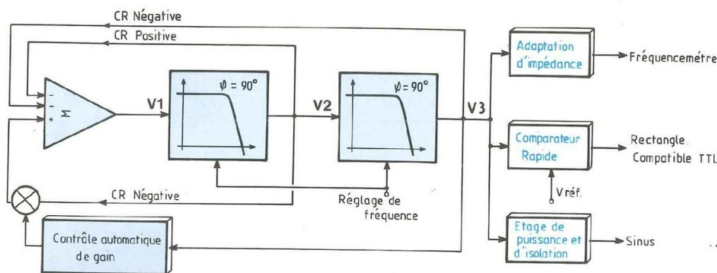
◀ Fig. 2 : Adaptation du montage en oscillateur à faible distorsion
