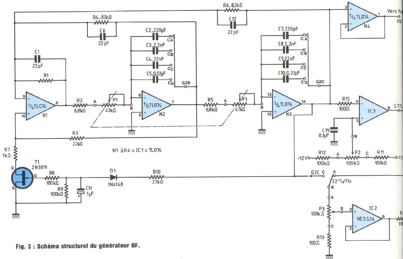
Fig. 3 : Schéma structurel du générateur BF.
