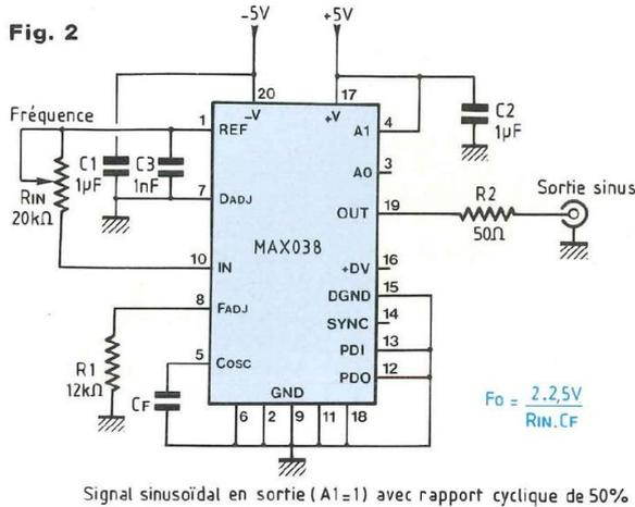
Signal sinusoïdal en sortie (A1=1) avec rapport cyclique de 50%
