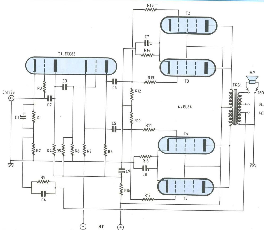
Un condensateur de faible valeur (22 pF) est placé en contre-réaction entre plaque (Anode) et grille de l'ECC83.
