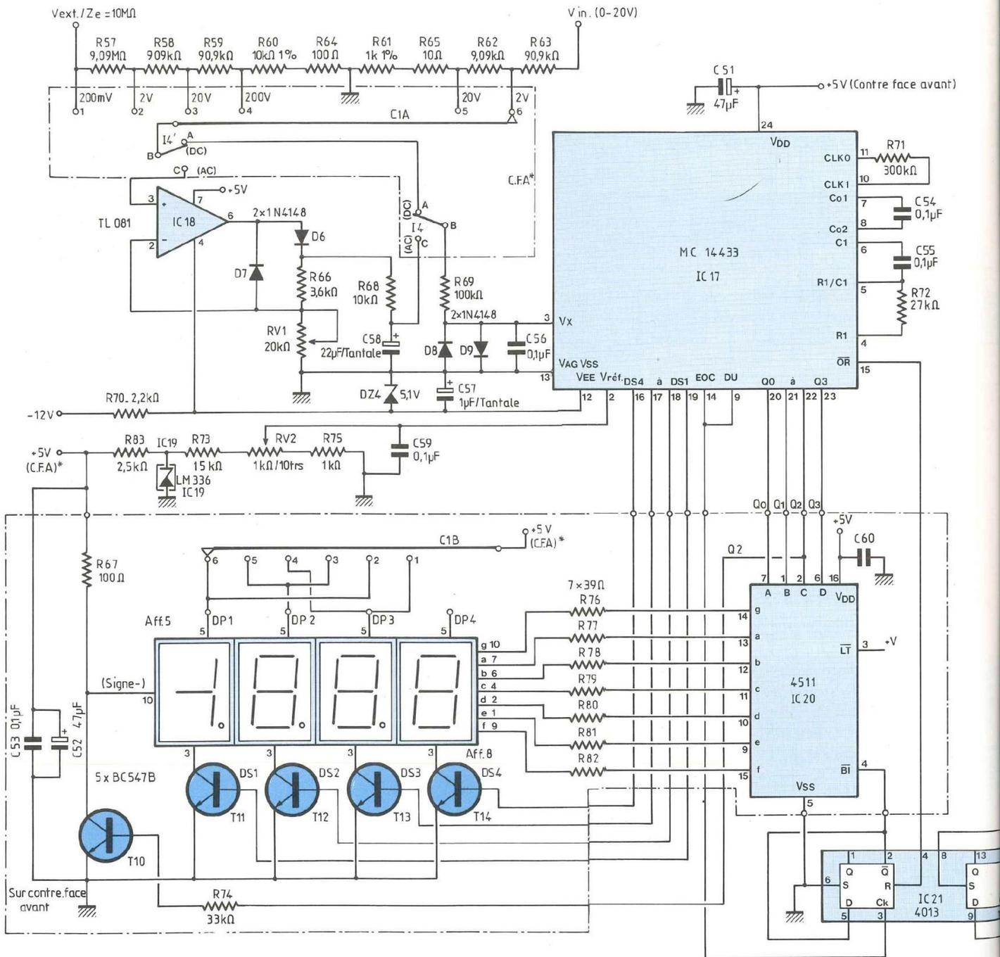
Fig. 11 : Schéma structurel du volt-mètre.
