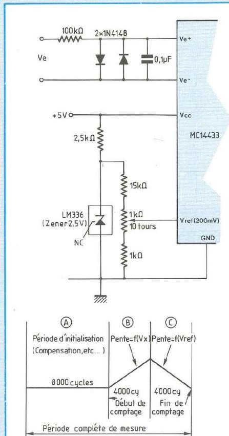
**Fig. 10 :** Principe de la conversion à double rampe.
