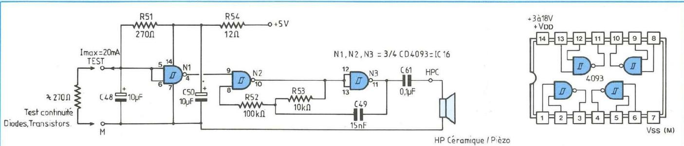
Fig. 15 : Schéma structurel du testeur de continuité.
