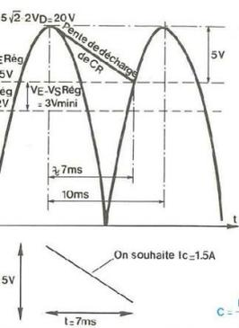
**Fig. 3b : Dimensionnement du condensateur (VTRANSFO = 15 V eff).**
