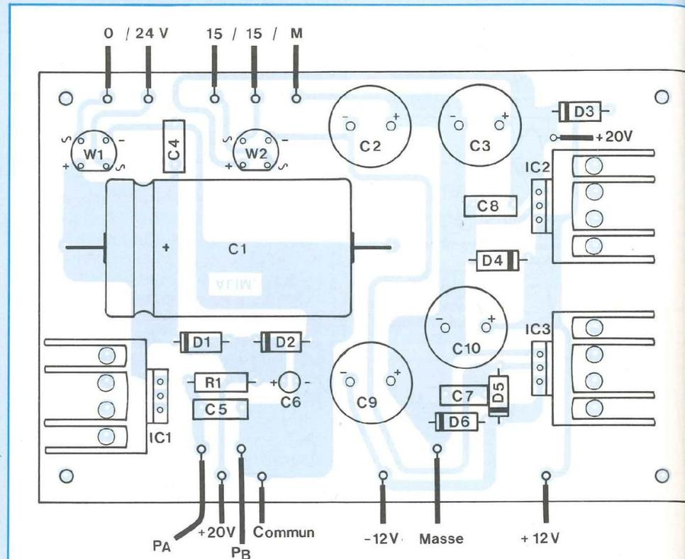
Fig. 4 : Implantation et tracé des pistes de l'alimentation.
