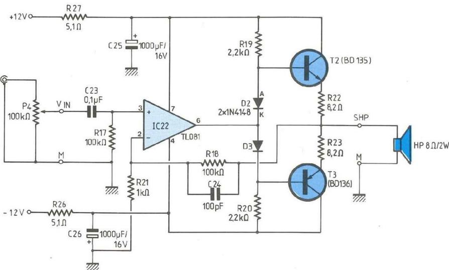
Fig. 13 : Schéma structurel de l'amplificateur.
