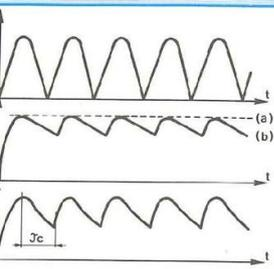
**Fig. 3a : Rôle des condensateurs de filtrage.**
