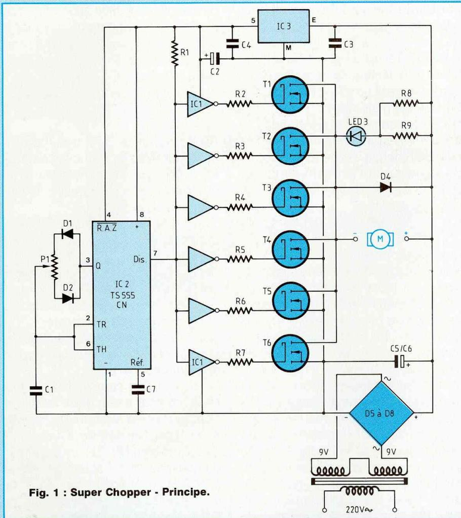
Fig. 1 : Super Chopper - Principe.
