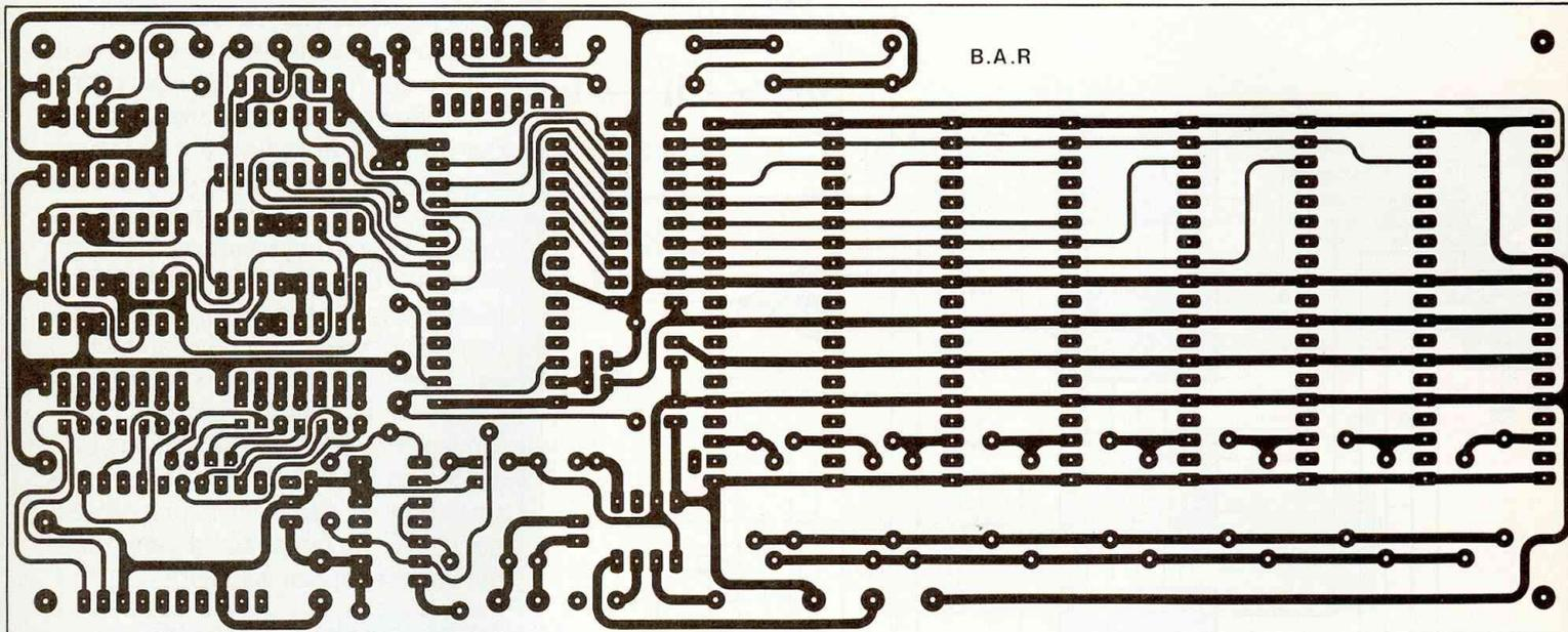
Fig. 5 : Tracé des pistes côté cuivre.
