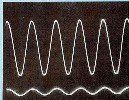
En haut : signal aux bornes d'une charge de 8  $\Omega$  connectée en sortie du TDA 1514A et à  $f=1 kHz$ . En bas, signal du générateur injecté dans le Jack E1. La sensibilité d'entrée pour  $P_{max}$  est de 45 mV<sub>eff</sub>.
