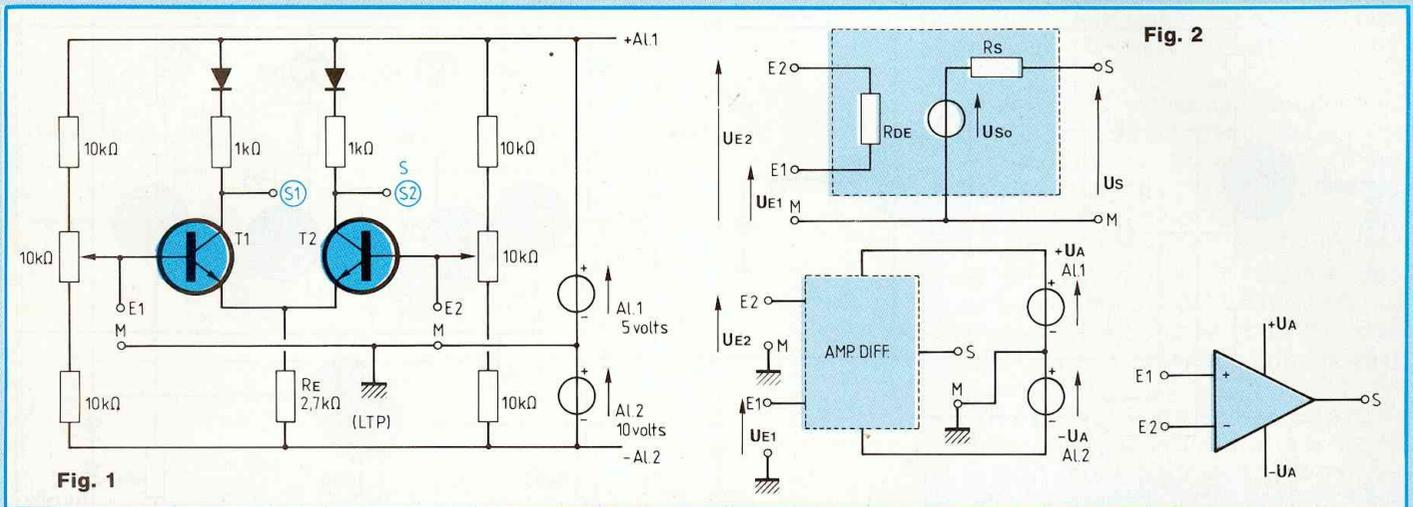
La tension sortie S1, sur le collecteur de T1, est en opposition de phase avec la tension entrée E1, sur la base de T1 et aussi avec celle d'émetteur de T1, donc également avec celle de T2 (pour cause de couplage direct des émetteurs !).
