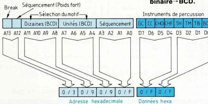
Fig. 10a : Représentation binaire et codage hexadécimal.
