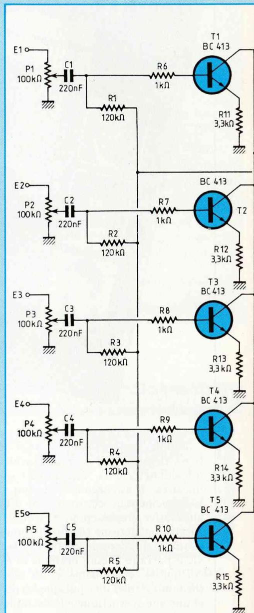
Fig. 2 : Schéma de principe de la section "mélangeur".
