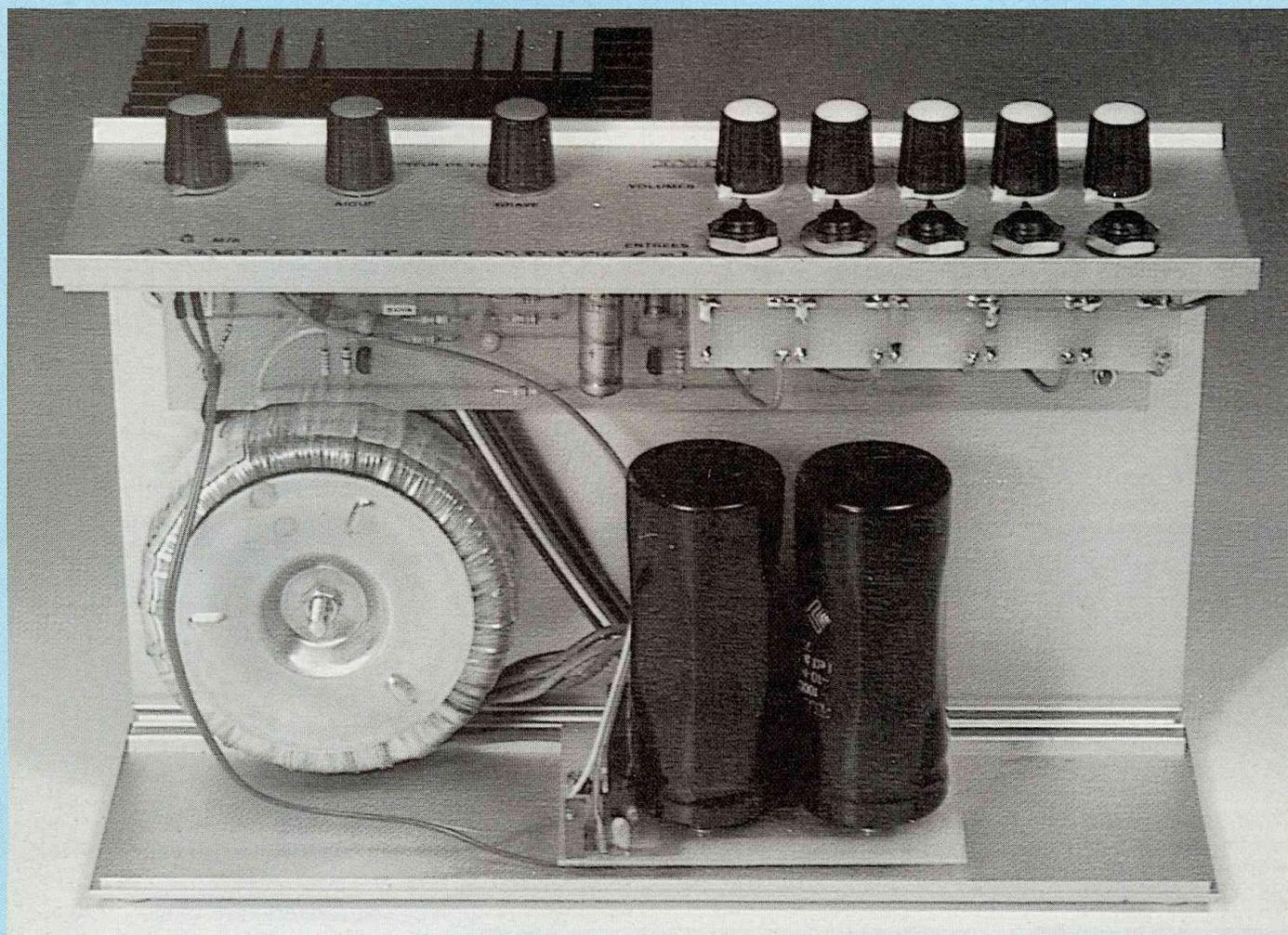
Disposition des modules à l'intérieur du coffret Iskra. Le module mélangeur est fixé par deux vis de 3 x 35 mm.
