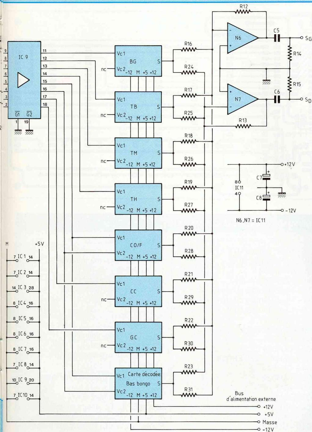
Fig. 3 : Commande des générateurs et sortie stéréophonique.
