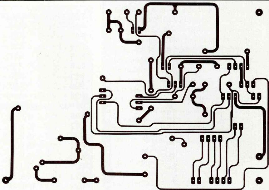
Fig. 6 : Tracé des pistes côté composants.
