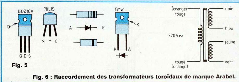
Fig. 6 : Raccordement des transformateurs toroïdaux de marque Arabel.
