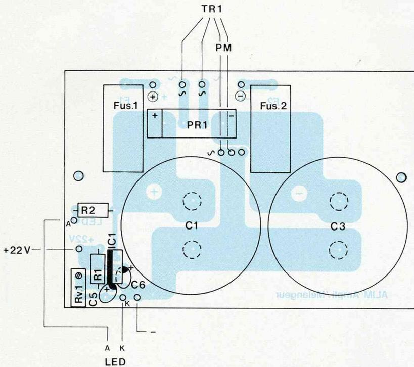
**Fig. 11 : Le circuit imprimé de l'alimentation reçoit tous les composants (à l'exception du transformateur torique). Attention à l'orientation de la semelle de refroidissement du régulateur IC1. Les gros condensateurs C1 et C3 sont directement vissés au module sans brides de maintien.**
