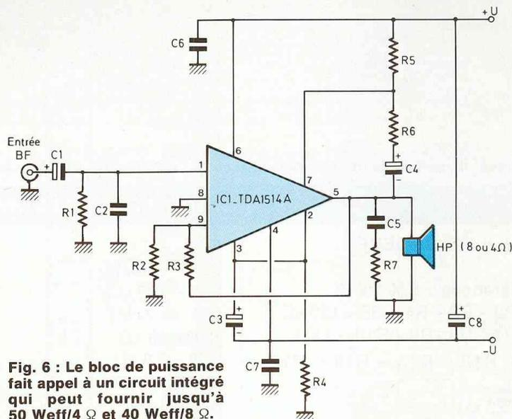
Fig. 6 : Le bloc de puissance fait appel à un circuit intégré qui peut fournir jusqu'à 50 Weff/4 Ω et 40 Weff/8 Ω.
