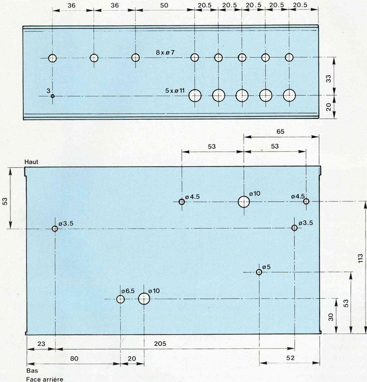
Fig. 12 : Plan de perçage du coffret Iskra/80255.
