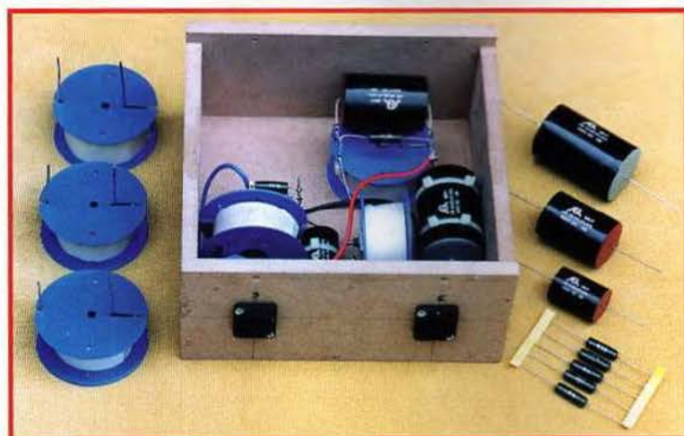
ENSEMBLE DES COMPOSANTS DU FILTRE PASSIF 2 VOIES SELS. CONDENSATEURS. RÉSISTANCES. PRISES SPEAKON MÂLE / FEMELLE
