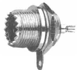
figura 3 - Presa coassiale da pannello tipo SO-239, con pagliuzza di massa, fissaggio a vitone e isolamento in Derlin.
