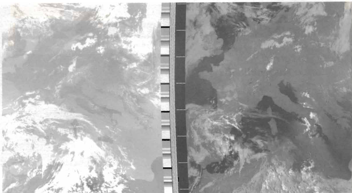
figura 2 - Immagine NOAA APT con i canali A e B (visibile ed infrarosso) derivati direttamente dai 5 HRPT, si noti la curvatura dell'immagine dovuta all'effetto doppler.
