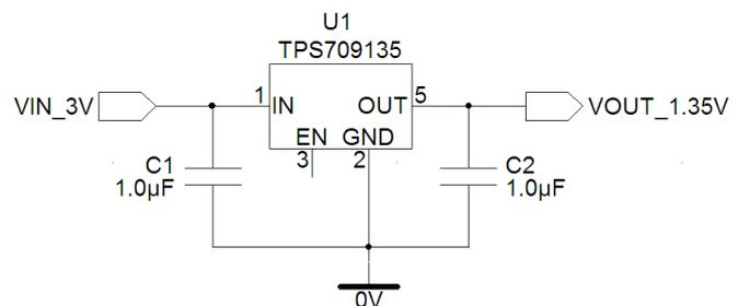
Deux condensateurs de découplage de 1µF, en entrée et en sortie du régulateur, assurent sa stabilité.
