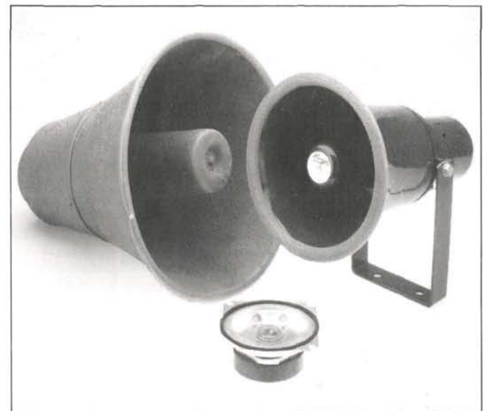
Figure 5 - Voici trois modèles de haut-parleurs spéciaux pour mégaphone. Leur caractéristique essentielle est l'étanchéité. Leur forme conique n'est pas seulement impressionnante pour l'oeil, mais aussi pour l'oreille. Le gigaphone fonctionne toutefois aussi avec un bon HP ordinaire.
