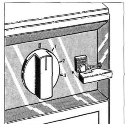
Figure 2 - La photorésistance est placée de façon à n'être excitée que par le témoin de fonctionnement de l'appareil à surveiller, un four ici. Il faut l'isoler de la lumière du jour à l'aide d'un matériau opaque, sans pour autant recouvrir la loupette dont l'utilisateur de l'appareil a toujours besoin pour savoir si celui-ci est sous tension.
