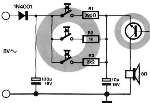
transistor est devenu passant, le condensateur s'est donc déchargé brutalement. Après cela, le transistor se bloque à nouveau, le condensateur se recharge et le cycle reprend.
