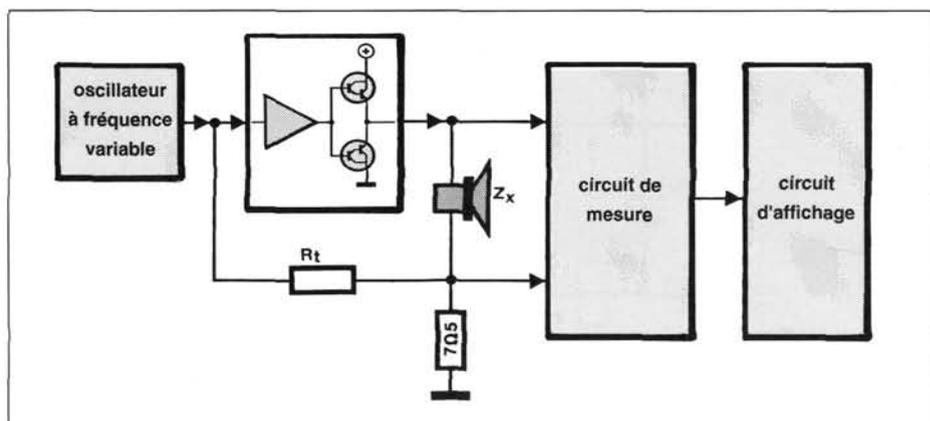
Figure 1 - La mesure d'impédance est en fait une mesure de tension. La tension (alternative) mesurée aux bornes du haut-parleur est affichée sur une échelle graduée en ohms.
