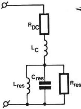
Figure 3 - Le haut-parleur se comporte comme un circuit complexe correspondant au schéma équivalent ci-dessus. Il s'agit de tout autre chose qu'une simple résistance.
