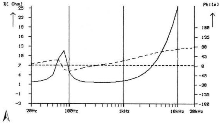
Figure 4 - L'ordinateur et les programmes de simulation de circuit permettent de calculer le comportement du circuit équivalent du haut-parleur. La ressemblance avec la figure 2 est frappante : le schéma équivalent de la figure 3 est assez proche du modèle réel. La ligne pointillée représente le déphasage, dont il faut tenir compte aussi lors du calcul d'un filtre.
