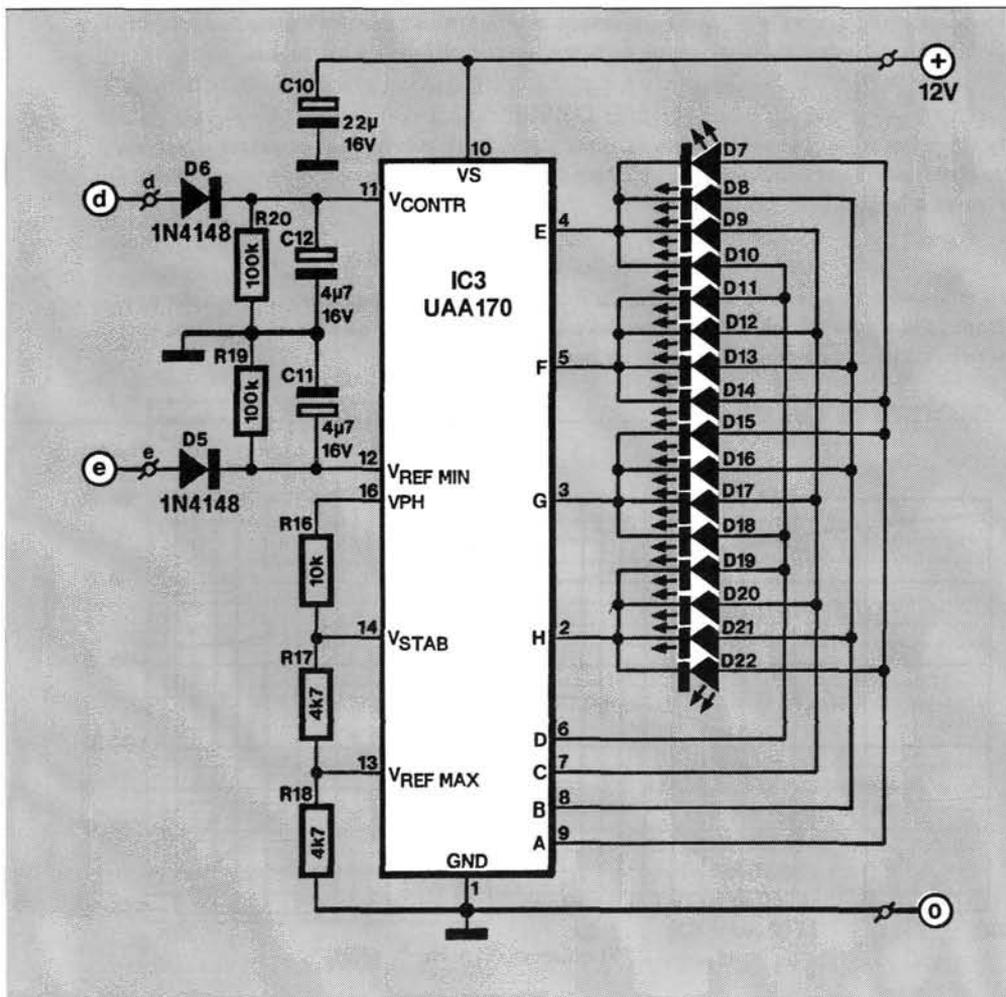
Figure 2 - Le schéma se divise en deux parties, pour la commodité de lecture. L'oscillateur et l'amplificateur d'une part, l'afficheur d'autre part.
