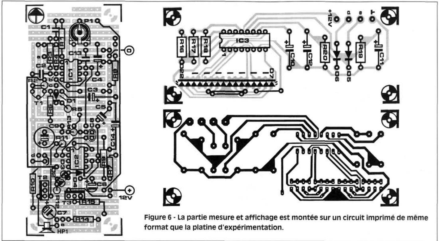
Figure 6 - La partie mesure et affichage est montée sur un circuit imprimé de même format que la platine d'expérimentation.
