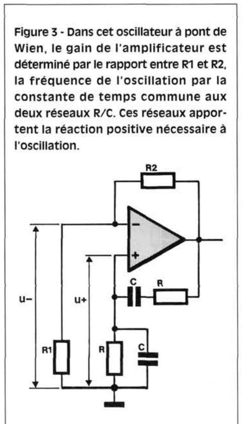
Figure 3 - Dans cet oscillateur à pont de Wien, le gain de l'amplificateur est déterminé par le rapport entre R1 et R2, la fréquence de l'oscillation par la constante de temps commune aux deux réseaux R/C. Ces réseaux apportent la réaction positive nécessaire à l'oscillation.
