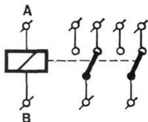
Figure 1 - Le principe de fonctionnement d'un relais : un électro-aimant attire une armature reliée par un isolant aux contacts. En b, le symbole correspondant. Le rectangle barré représente la bobine de l'électro-aimant. Les relais comportent souvent, comme celui-ci, plusieurs contacts. Dans cet exemple, il y a deux contacts supplémentaires, fermés quand la bobine n'est pas alimentée, quand le relais est au repos. On les appelle contacts « repos », le relais est dit à 2 RT (repos-travail).
