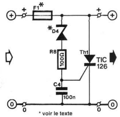
Figure 3 - L'entrée de ce circuit n'est pas loin de la sortie, ce n'est pas une raison pour vous tromper en le câblant : en reliant l'alimentation à la sortie, le fusible, de protecteur, devient protégé et le thyristor dégage à la première surtension, entraînant éventuellement l'alimentation avec lui.
