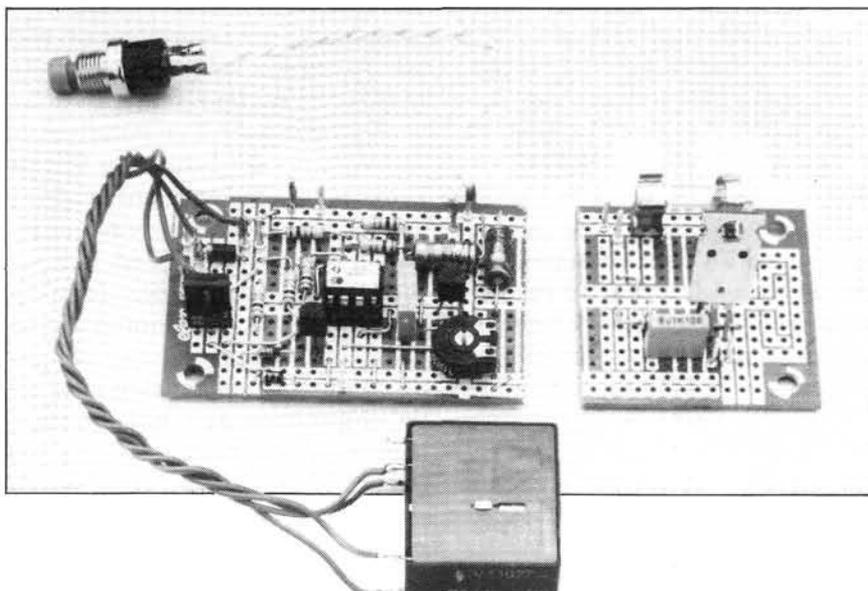
Figure 4 - Les deux circuits sont réunis sur une seule platine, à découper suivant le pointillé. L'entrée du circuit à relier à l'alimentation est désignée par une flèche blanche, la sortie par une flèche noire. Le trait gras dont sont pourvus T3 et Th1 correspond à la languette de refroidissement métallique de ces composants.
