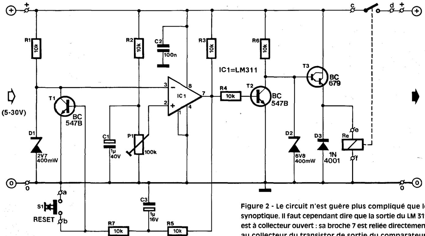
Figure 2 - Le circuit n'est guère plus compliqué que le synoptique. Il faut cependant dire que la sortie du LM 311 est à collecteur ouvert : sa broche 7 est reliée directement au collecteur du transistor de sortie du comparateur. L'entrée est à gauche et la sortie à droite : il n'y aurait cependant pas grand mal si vous les intervertissiez !
