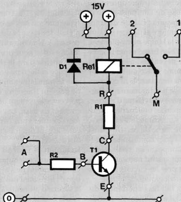
de fois celle du courant de collecteur du transistor. L'inconvénient de la lenteur peut être négligé quand il s'agit de commuter à intervalles de quelques secondes comme ce sera le cas ici. La lenteur des relais est d'origine mécanique : si on commande les contacts à une fréquence trop élevée, leur inertie les empêche de suivre les ordres instantanément ; ils commencent à vibrer et, si la fréquence augmente encore, ils ne bougent plus du tout.
