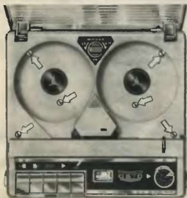
Fig. 2 - Smontaggio del mobile
