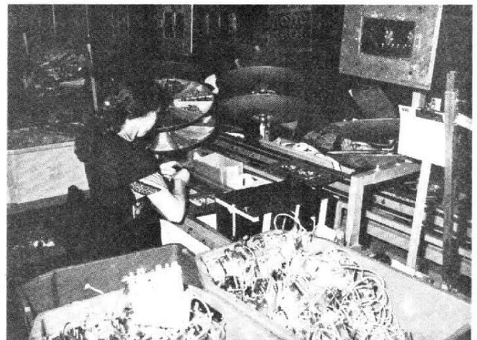
Photo 6. – Montage des composants. Au-dessus des postes de travail circulent des plaques servant au transfert des circuits de poste en poste.
