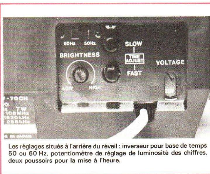
Les réglages situés à l'arrière du réveil : inverseur pour base de temps 50 ou 60 Hz, potentiomètre de réglage de luminosité des chiffres, deux poussoirs pour la mise à l'heure.
