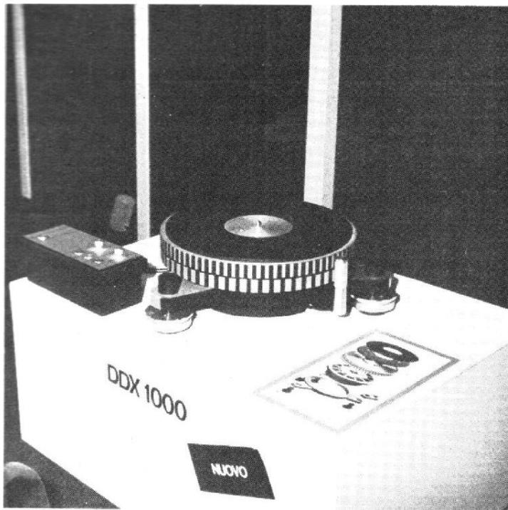
Fig. 1. - Table de lecture Micro DDX 1000. Emplacement prévu pour trois bras de lecture (sur les pieds, boîtier de commande séparé, entraînement direct bien entendu).
