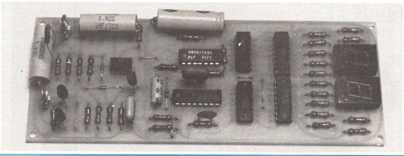
La silistance sera câblée au choix directement sur le circuit, ou à tout autre endroit où l'on désire prélever la température, les liaisons au circuit étant effectuées par deux fils souples de faible section. On prendra bien soin d'orienter cette silistance de façon à ce que l'anneau imprimé (comme pour une diode) se trouve à gauche lorsqu'il considère le circuit comme à la figure 3.
