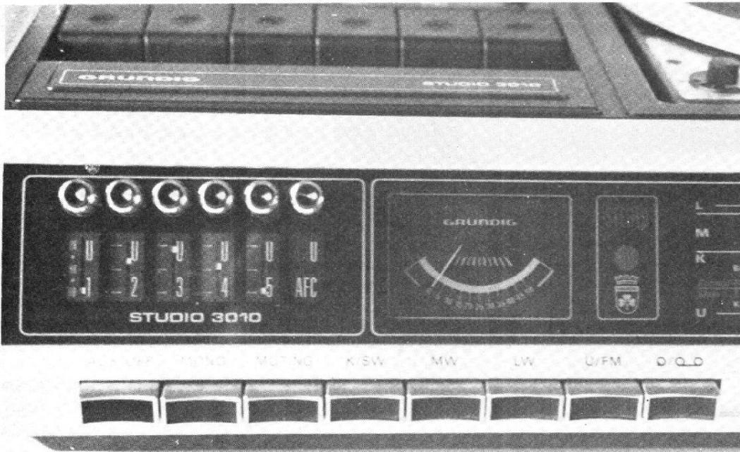
Photo A. - A droite : tuner FM à 6 touches de présélection au centre le vumètre d'accord.
