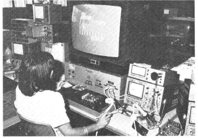
Photo 8. - Réglage d'un module, il s'agit ici d'une horloge pilotée par quartz et permettant d'afficher l'heure et aussi les programmes sur l'écran. Pour les téléviseurs PAL. Version Secam à venir.
