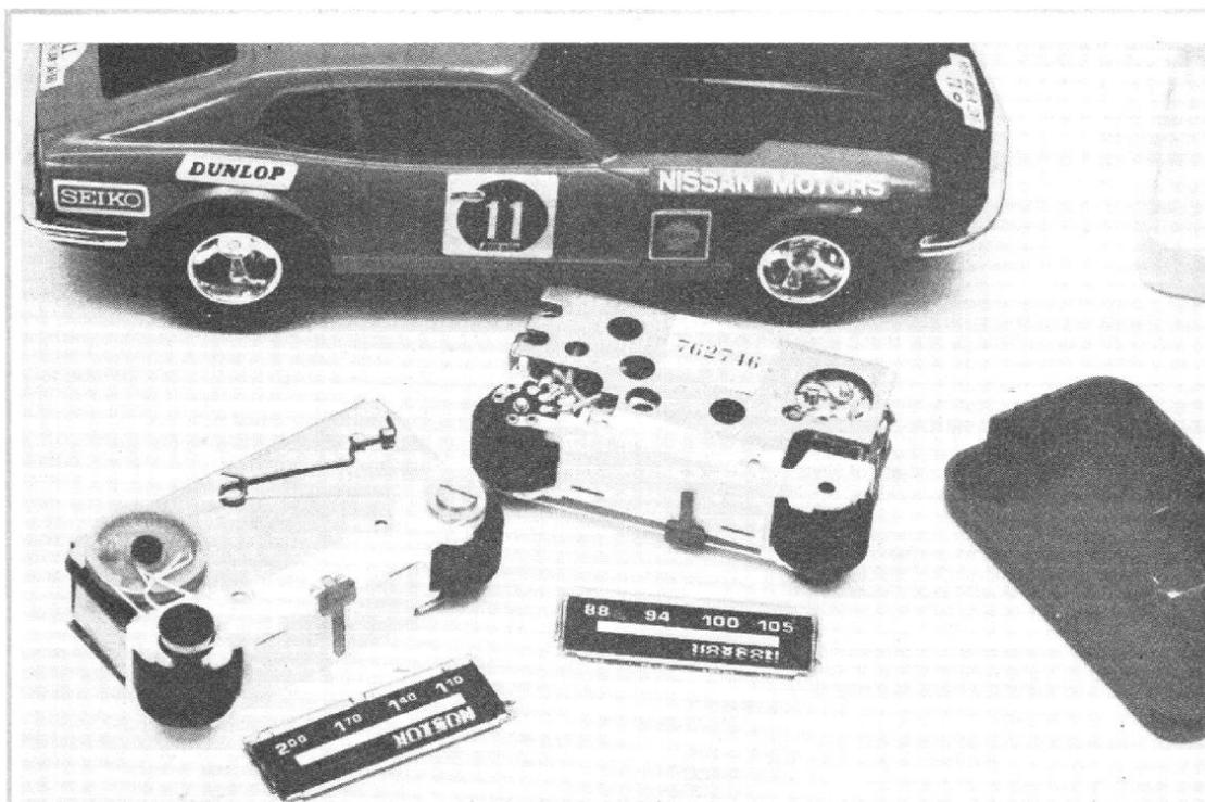
Photo 4. - Deux des modules, côté pile et côté face, on voit ici le mécanisme d'entraînement de l'axe du condensateur variable et le ressort de tension du câble de commande, sur le module du milieu, on se rend compte de la qualité du blindage, et on distingue les ouvertures qui permettent le réglage des modules.
