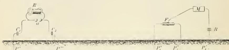
Fig. 177. — Système Braun. Dispositions générales d'un poste de transmission et d'un poste de réception.
