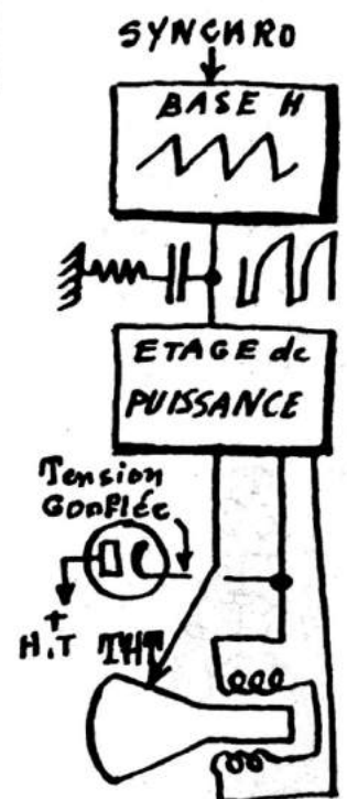
Fig. 3-3. — Oscillateur bloqué pouvant se substituer au multivibrateur de la figure 2-7.
