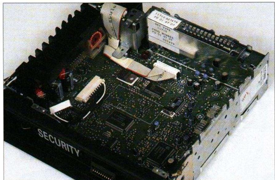
Un circuit imprimé placé au fond reçoit des composants de surface, l'espace libre sera occupé par la platine de lecture de CD. Au fond, le module du tuner totalement blindé et, à gauche, les deux circuits intégrés des amplis de puissance montés sur un radiateur moulé.
