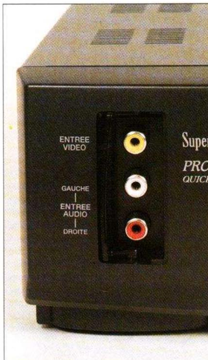
Sur la gauche de la face avant, trois prises recevront les signaux de sortie d'un caméscope.
