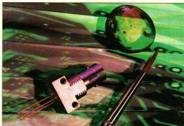
La LED Mitel MF 430 a été conçue comme une solution économique à utiliser avec les liaisons optiques sur courtes distances, grâce à une longueur d'onde de 865 nanomètres. Ce dispositif très rapide, qui fonctionne jusqu'à 155 Mb/s, utilise la technologie GA Al As et comporte un connecteur ST à alignement actif pour assurer le couplage optimal de l'énergie vers la fibre. Ce dispositif est optimisé
