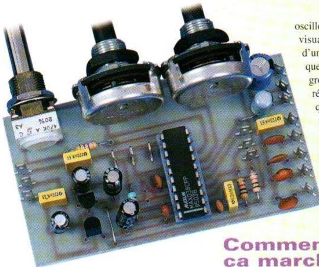
oscilloscope afin de faciliter la visualisation des signaux, d'un double réglage de fréquence avec un bouton « gros » et un « fin » et d'un réglage du rapport cyclique. Malgré cela, il tient sur un circuit imprimé de seulement 36 cm<sup>2</sup> et coûte moins de 300 Francs grâce à l'emploi du désormais célèbre MAX 038 de Maxim.
