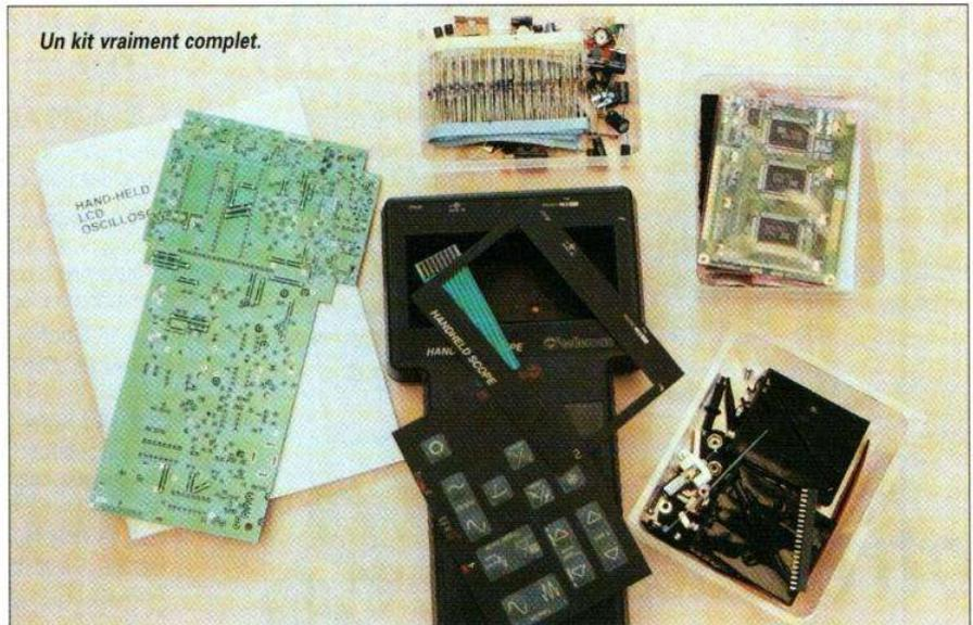
Contrairement à ce que l'on pourrait croire, ce kit ne se résume pas à un simple assemblage de modules précâblés en usine comme nous l'avons quelquefois vu faire. Il s'agit en effet d'un «vrai» kit pour lequel il faut jouer, assez longuement d'ailleurs, du fer à souder. Les nostalgiques de Heathkit apprécieront certainement et tout ceux d'entre-vous qui n'ont jamais eu le plaisir de monter un kit de qualité bien conçu également.
