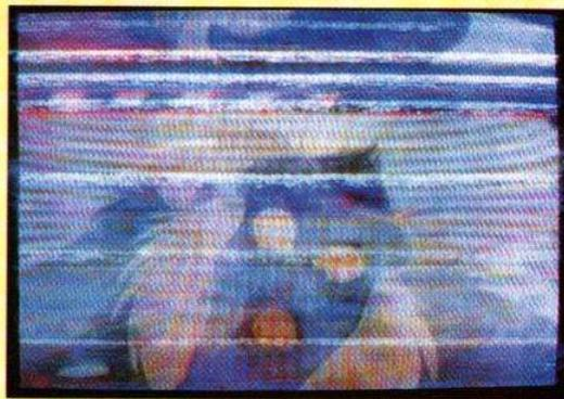
Photo 2 : instabilité de la synchro et du réalignement.
