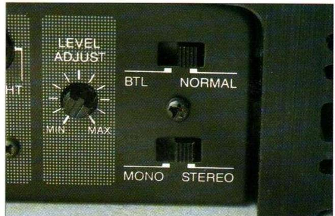
Des réglages à laisser accessibles ! : niveau d'entrée, pontage sur un ampli moderne
