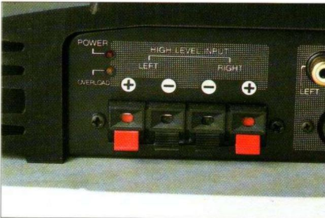
Les entrées haut niveau d'un ampli, celles qui peuvent être raccordées aux sorties HP d'un combiné.
