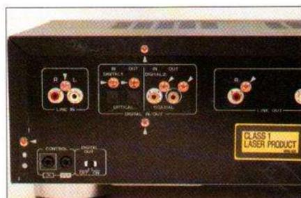
L'analogique côtoie le numérique avec des prises RCA pour une liaison coaxiale ou Toslink pour l'optique. Pioneer a aussi installé des prises d'interface pour une télécommande.
