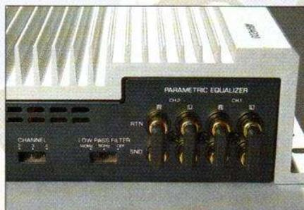
Vraiment impressionnant cet amplificateur qui occupe un volume des plus conséquents. En tout cas nettement supérieur à celui de ses concurrents de puissance similaire. Les raccordements utilisent des connecteurs classiques : borniers dorés pour cosses et prises Cinch. Il existe une sortie ligne pour chaîner un autre amplificateur dans une installation de grande ampleur et, surtout, en retirant les cava-
