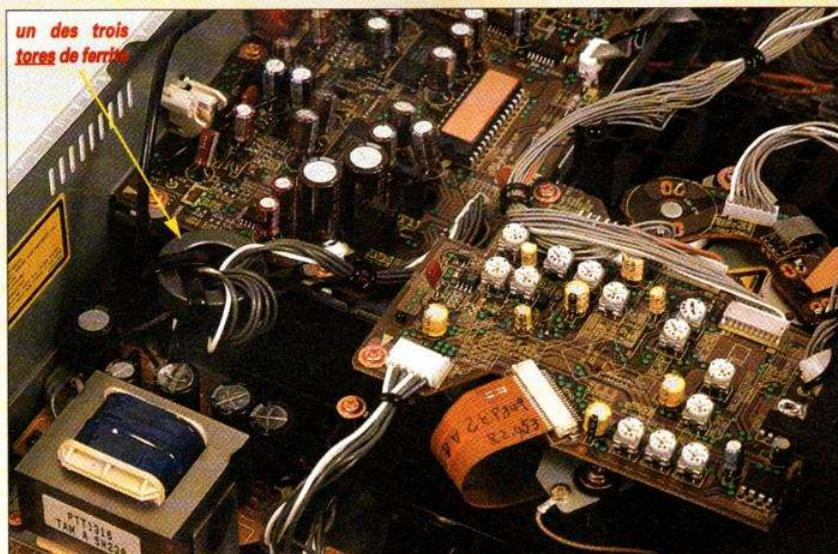
*L'un des trois tores de ferrite installés sur les câbles. Il est là pour assurer la compatibilité électromagnétique. Sur la droite, la platine électronique de l'enregistreur, les réglages sont nombreux. Au fond, le circuit "Legato S" est caché sous un épais écran de cuivre.*
