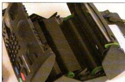
Le ruban encreur remplace le rouleau de papier thermique. Il défile à la vitesse du papier, son encre se transfère au passage sur la barrette des têtes thermiques.
