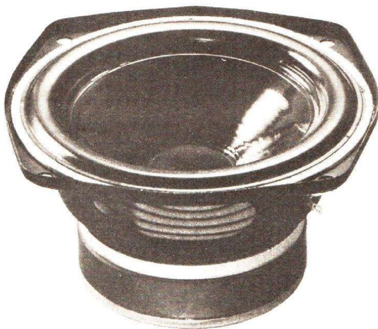
Fig. 39. — Haut-parleur de 13 cm à membrane. Bextrène, suspension externe en butyl et à large spider en nylon assurant à la fois grand débattement et référence inférieure à 35 Hz (réalisation Audax).
