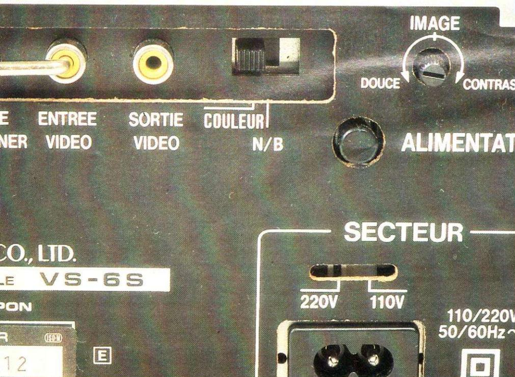
Photo 5. - L'arrière de l'appareil avec le cavalier pour la liaison tuner/entrée vidéo.
