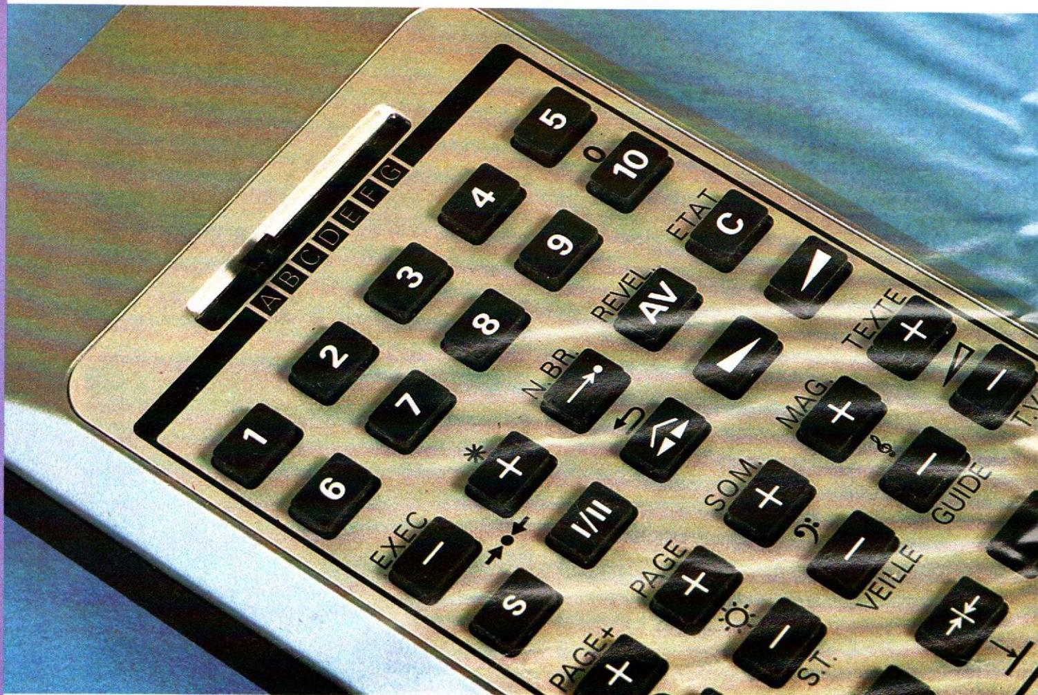
Photo 9. - En haut du boîtier de télécommande, un sélecteur permet de choisir entre sept récepteurs, pour Antiope, c'est la position B.
