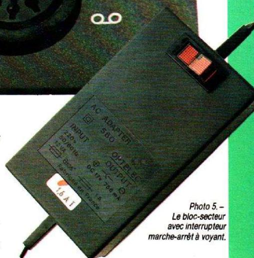
Photo 5. - Le bloc-secteur avec interrupteur marche-arrêt à voyant.
