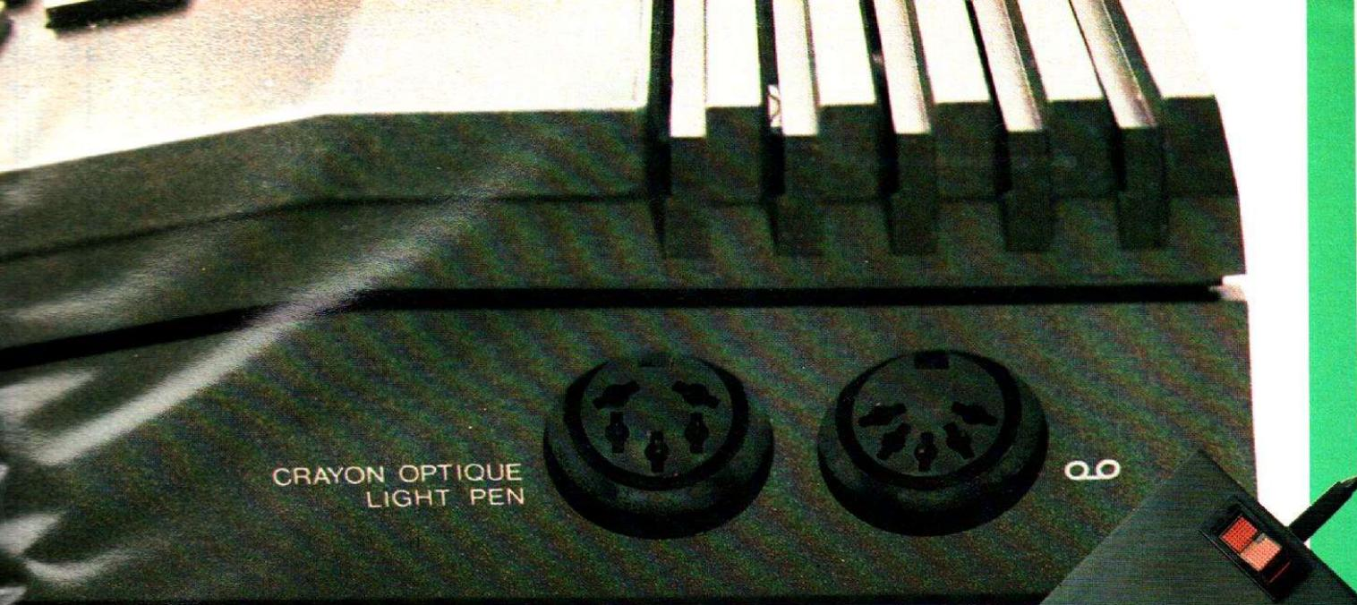
Photo 3. - Les prises DIN pour le magnétophone et le light pen.
