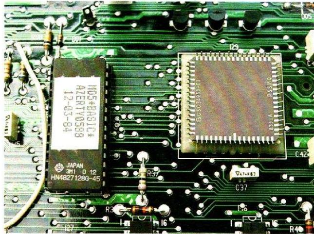
Photo 7. - La ROM 16 K-octets qui contient le Basic et un curieux circuit intégré qui doit être un réseau de portes (Gate Array).
