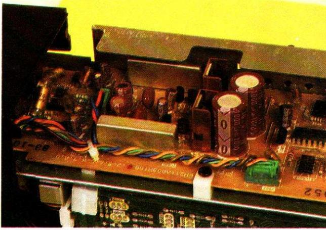
Photo G. – Le circuit de sortie et les filtres actifs.
