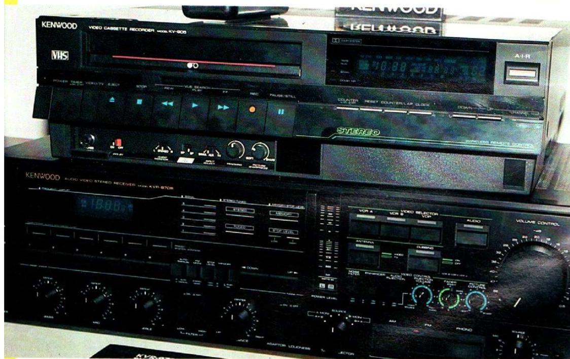
Amplificateur audiovidéo Kenwood avec, superposé, un magnétoscope stéréo à télécommande.
