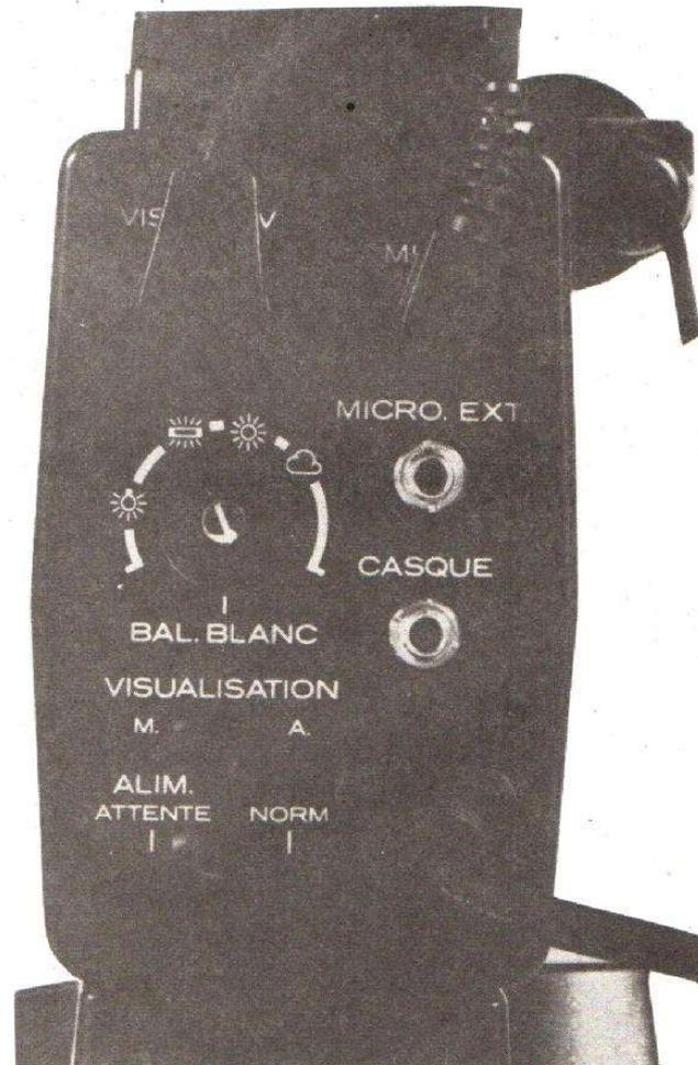
Photo 5. - Toutes les commandes de la caméra sont regroupées à l'arrière, là où les erreurs de manipulation deviennent difficiles. C'est aussi là que le micro et le viseur se branchent. Noter la commande unique d'équilibre des couleurs ne demandant pas de filtre.
