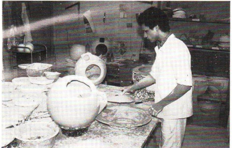
La fabrication des conques et boules en « staff » nécessite le tour de main.
