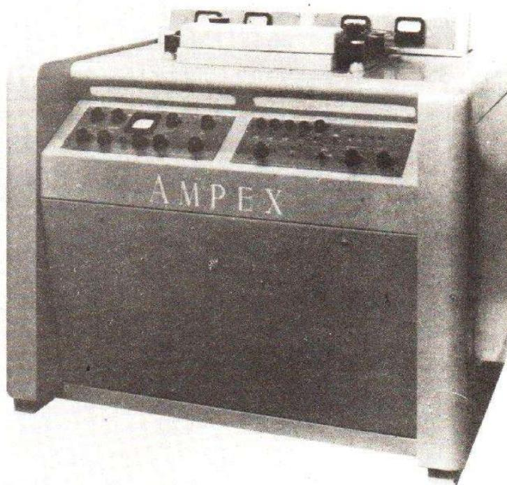
Photo 1. — Le VR 1000 Ampex, le premier magnéscope en 1956.
