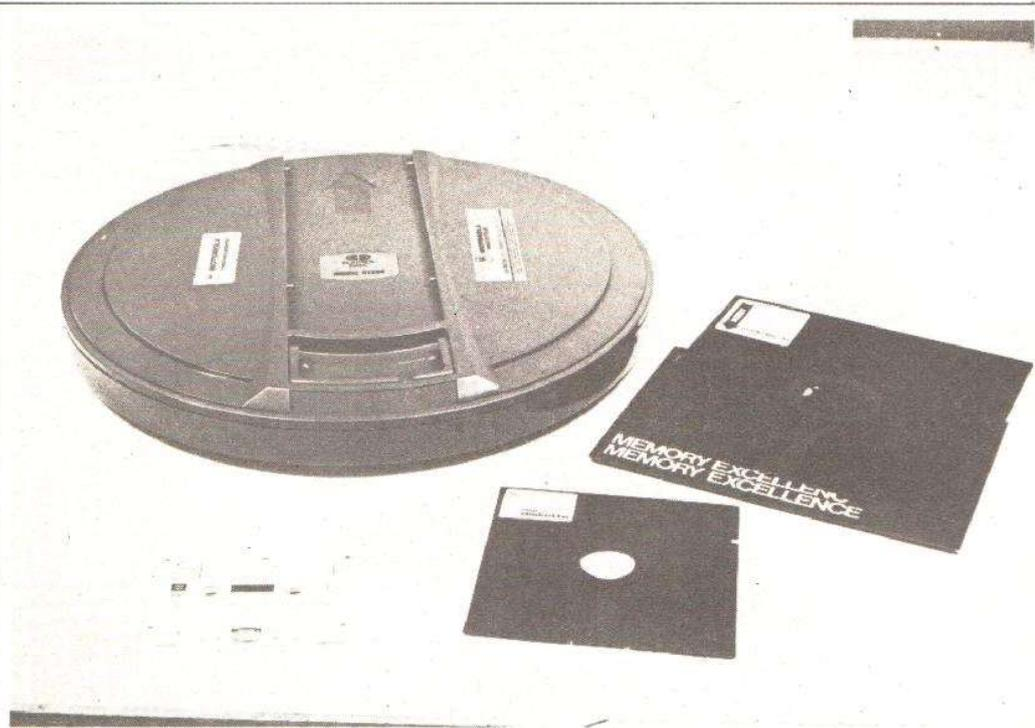
Photo 1. — Une cassette digitale, une disquette 5 pouces, une disquette 8 pouces et un disque dur.
