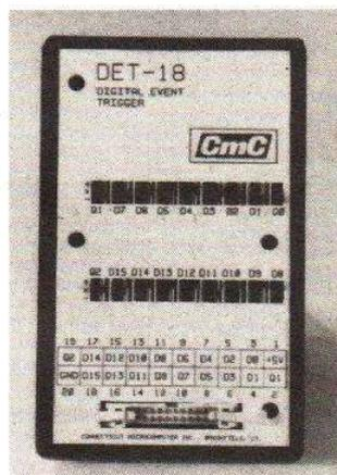
Les signaux entrés sur le DET-18 peuvent être une combinaison de lignes de données, d'adresses, de porte, d'écriture/lecture, d'horloge, etc. La synchronisation est assurée par l'une des voies utilisées comme signal d'horloge.
