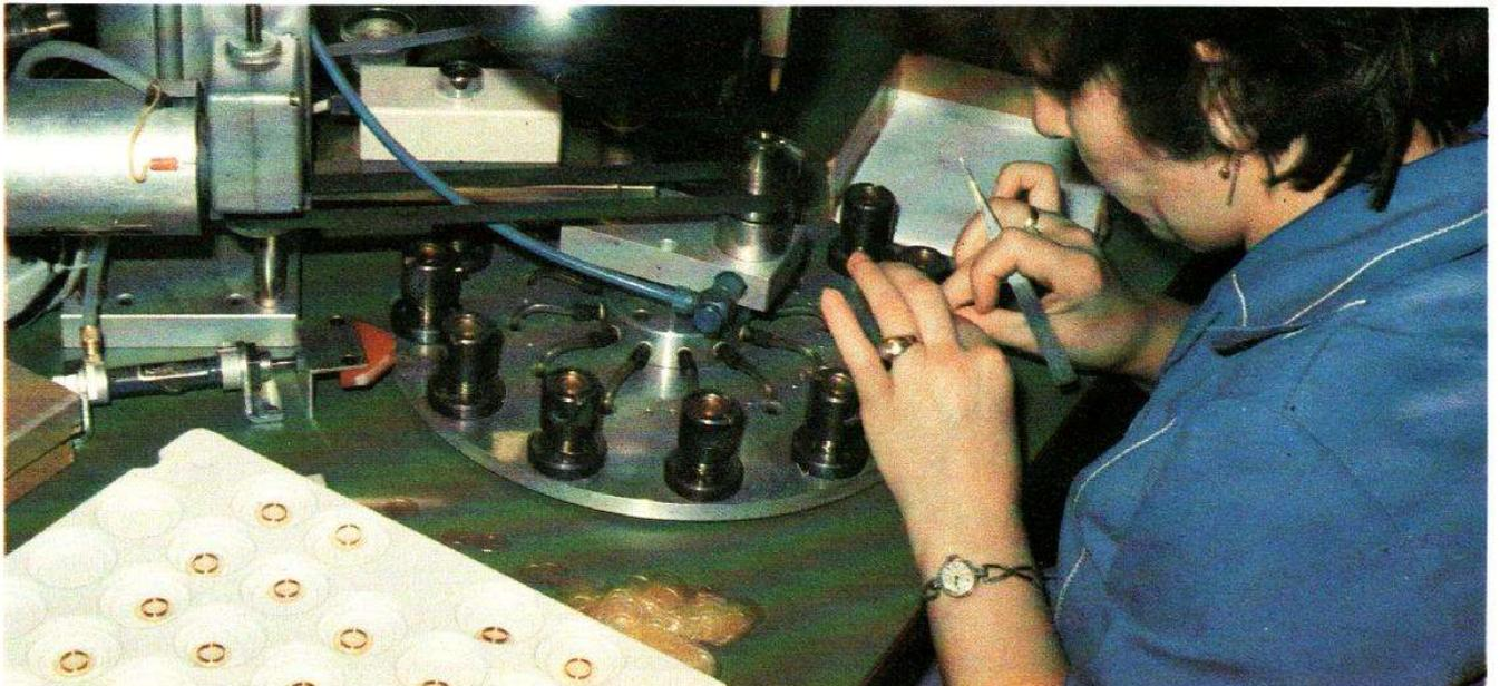
Photo 7. – Collage des bobines sur les membranes de microphones : là aussi, le doigt est de rigueur.
