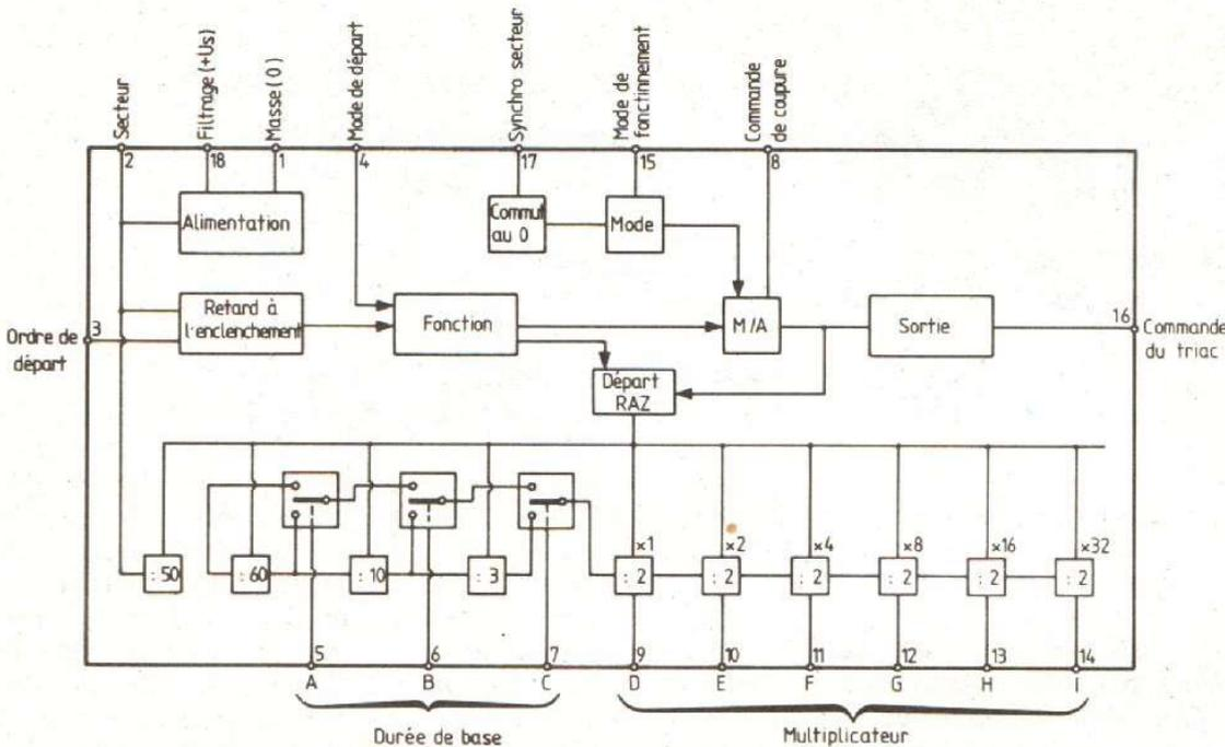
Fig. 1. — Schéma synoptique interne du circuit.
