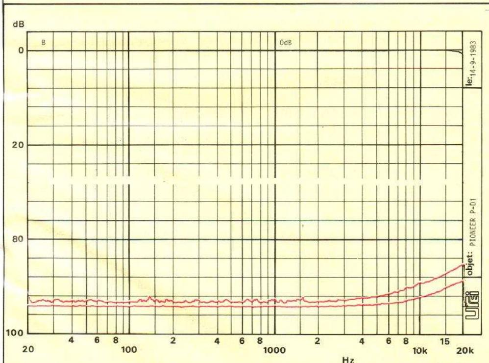
Courbe B. - La courbe de diaphonie d'un lecteur de disques numérique demande une coupure de l'échelle verticale comme on le constate à la discontinuité de l'échelle. A titre de comparaison, une courbe de diaphonie de cellule phonocaptrice analogique tiendrait pratiquement dans la partie du haut de la feuille...
