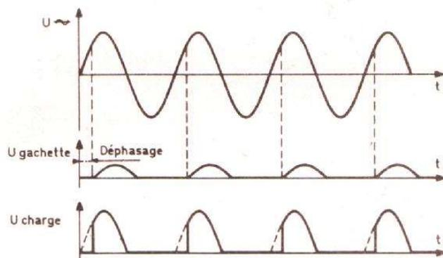
Fig. 9. — Explication simplifiée de la commande par déphasage.
