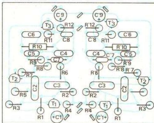
Fig. 27. — Implantation du filtre multiplex.
