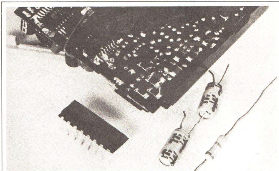
Photo 1. — Cette photo montre un coin du récepteur et ses composants hybrides. Le circuit intégré en premier plan est un récepteur MA/MF, on comparera sa taille à celle des boîtiers plaqués contre le circuit imprimé. Pour faire cette photo, nous avons relevé le circuit souple que l'on voit ici, on pourra donc intervenir, sans dessoudage de ce circuit, sur les composants du premier plan. Les condensateurs donnent une échelle différente, difficile d'imaginer construire un tel récepteur avec eux...
