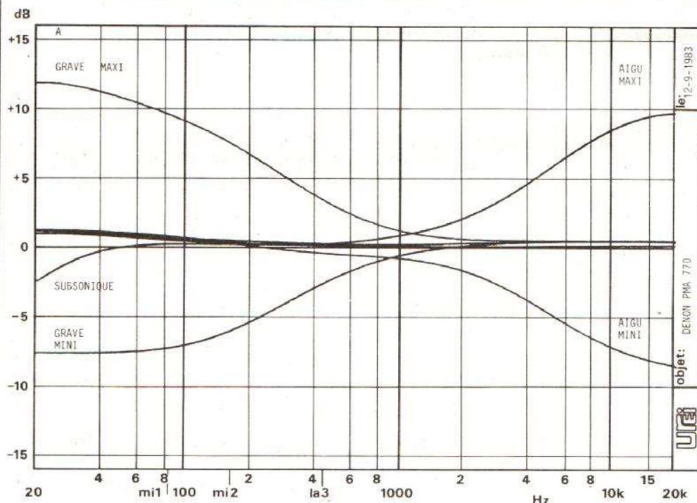
Courbes A. — Nous avons ici les courbes montrant l'efficacité de la correction de grave et d'aigu. Au centre, la courbe est celle de réponse du préamplificateur RIAA pour laquelle nous notons une légère remontée du grave, remontée inférieure à 1 dB à 20 Hz. Le filtre subsonique commence à agir à cet endroit. L'efficacité maximale de la correction est limitée à 10 dB, notons que la largeur de bande de la correction de grave permet à la correction d'atteindre le bas médium.
