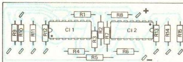
Fig. 21. — Implantation des composants de l'indicateur de niveau RF.
