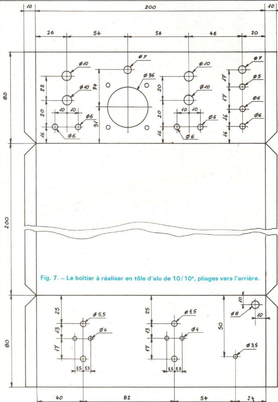
Fig. 7. - Le boîtier à réaliser en tôle d'aluminium de 10/10<sup>e</sup>, pliages vers l'arrière.
