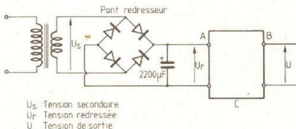
Fig. 4. — Schéma de principe d'une alimentation complète.
