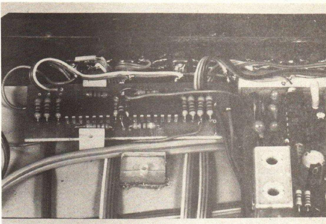
Photo F. — le circuit imprimé de l'indicateur R.f., câblé contre la face avant.
