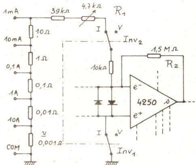
Fig. 3. - Adaptateur modifié pour la mesure des intensités.
