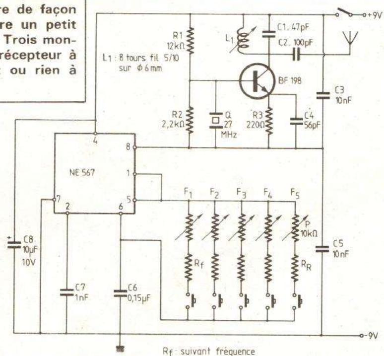
Fig. 1. - Schéma de principe de l'émetteur.
