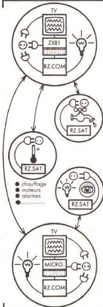
RZ.COM et ses satellites RZ.SAT associés à distance, permettent de commander des appareils électriques (lampes, radiateurs, moteurs, électrovannes, sirènes, postes radio, etc), effectuer des mesures de paramètres variés (lumière, humidité du sol, température, potentiomètre, etc) et communiquer avec d'autres ordinateurs (ZX81 ou liaison RS2 32 à 300 bauds).
