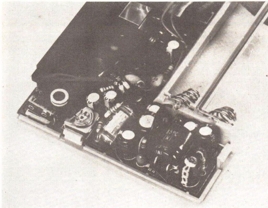
Photo 2. — Cette vue du récepteur montre les ressorts de contact des piles, nous avons également un paquet de condensateurs chimiques qui sont ici des modèles miniaturisés. A côté de la résistance ajustable, on voit le condensateur au polystyrène, condensateur du décodeur stéréo. Ce dernier est de l'autre côté du circuit imprimé.
