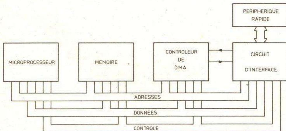
Fig. 1. — Synoptique d'utilisation d'un contrôleur d'accès direct mémoire.
