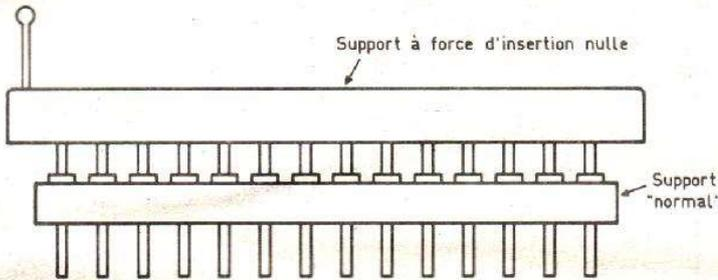
Fig. 7. - Montage du support à force d'insertion nulle.
