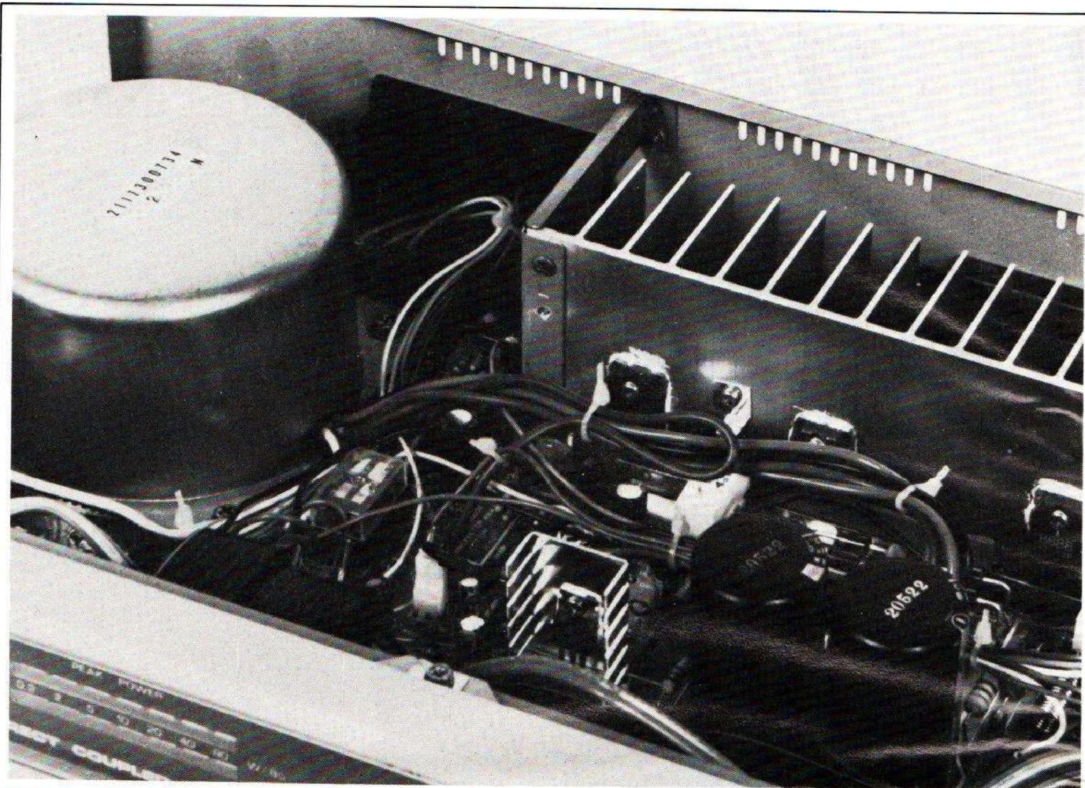
Photo 1. – Le transformateur toroïdal chargé de fournir l'énergie à l'amplificateur.
