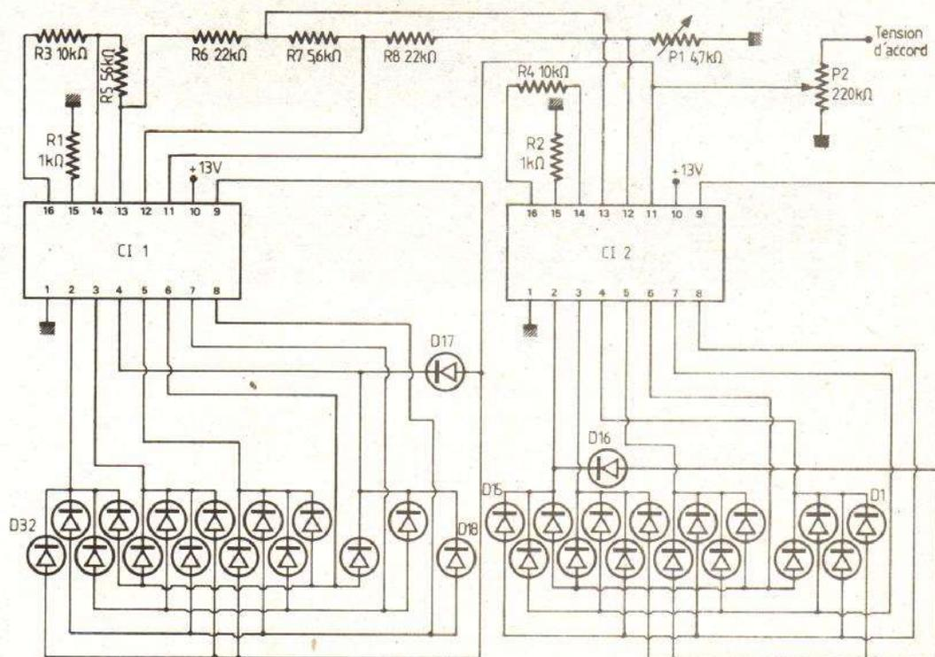
Fig. 11. - Schéma de principe de l'aiguille lumineuse.
