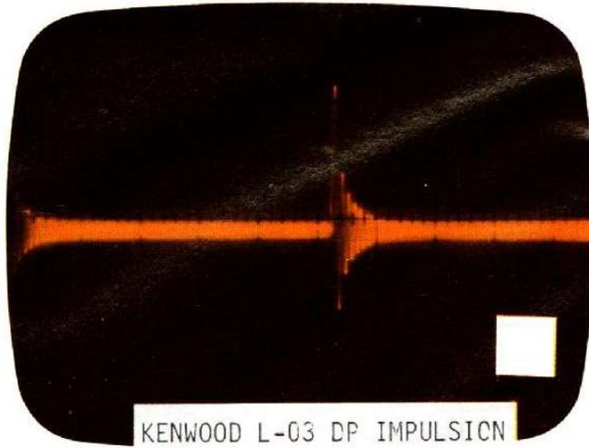
Photo 2. - Cette variante de la réponse en signaux carrés est due à un signal rectangulaire dont le rapport cyclique est de 1 à 127. L'échelle horizontale est de 500  $\mu$ s par division, la verticale de 2 V par division.
