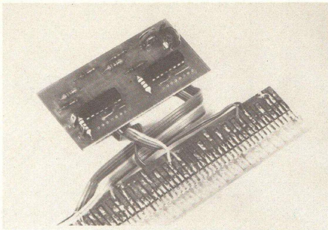
Photo E. - Le module de l'échelle lumineuse vu du côté composants.
