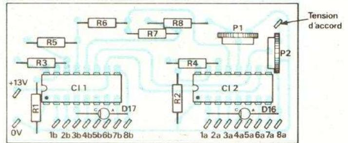
Fig. 13. - Implantation des composants du circuit de commande de l'aiguille lumineuse.
