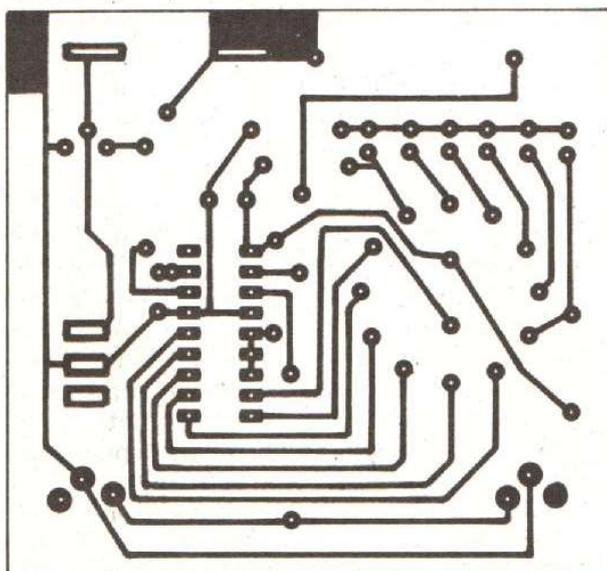
Fig. 3. - Circuit imprimé (échelle 1).
