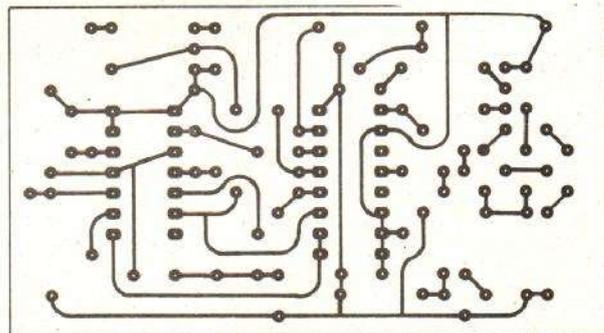
Fig. 23. - Circuit imprimé du module de commutation.
