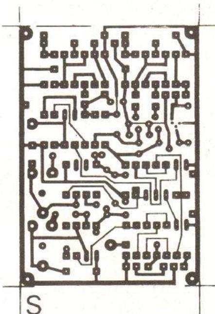
Fig. 2. - Le circuit imprimé de sécurité Gaz.
