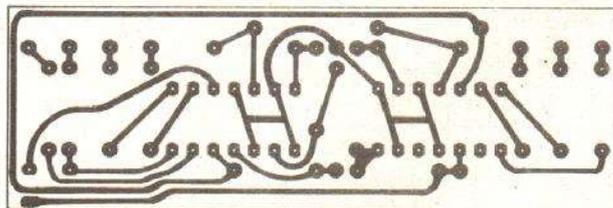
Fig. 20. — Circuit imprimé de l'indicateur de niveau RF.
