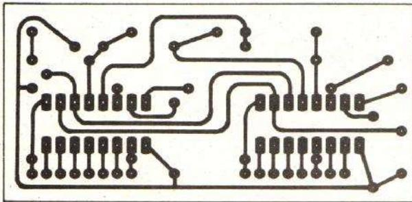
Fig. 12. - Circuit imprimé de commande de l'aiguille lumineuse.
