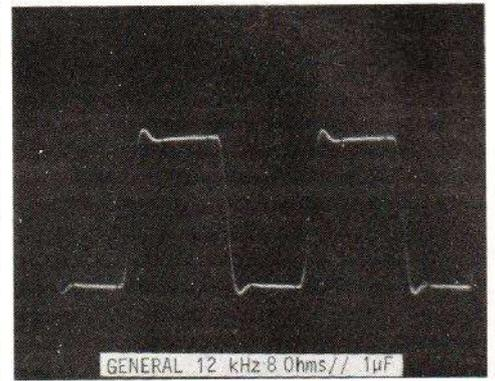
Réponse aux signaux carrés sur une charge capacitive de l'amplificateur General. On note une suroscillation d'amplitude particulièrement réduite. La charge de l'amplificateur est ici constituée d'une résistance pure de 8 Ohms, placée en parallèle sur un condensateur de 1µF.
