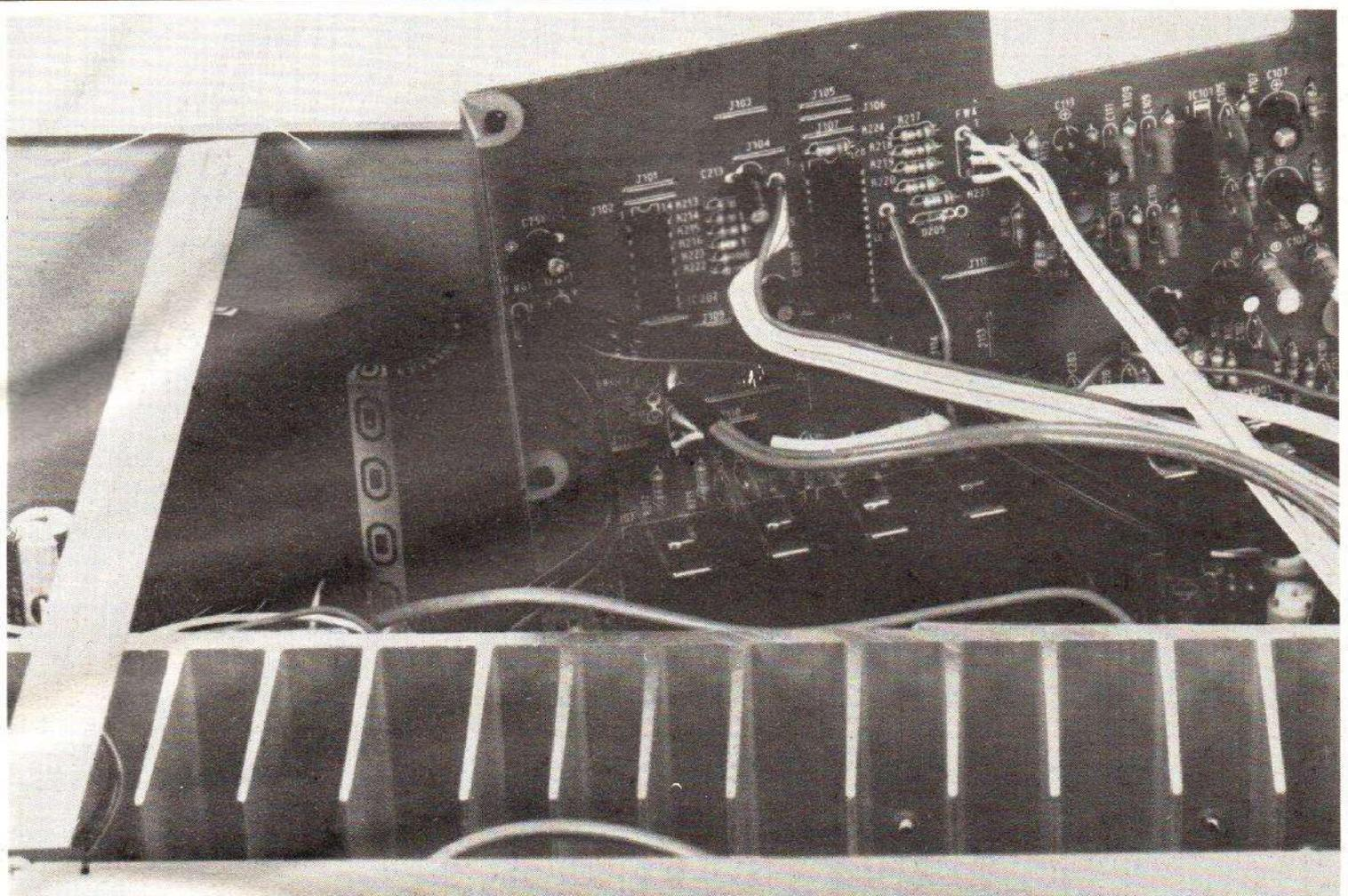
Photo 1. — Les deux circuits intégrés sont chargés des commutations.
