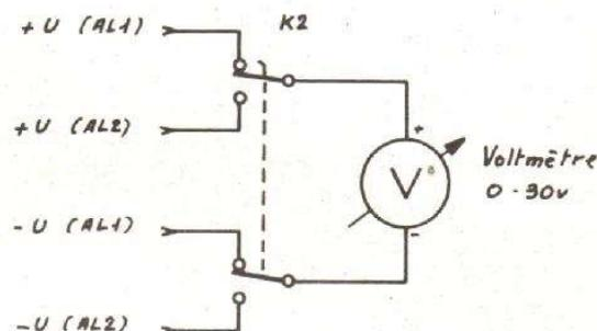
Fig. 4. - Le dispositif de commutation du voltmètre.
