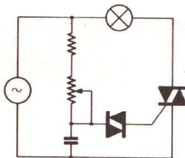
Fig. 16. - Triac commandé par diac avec circuit déphaseur.
