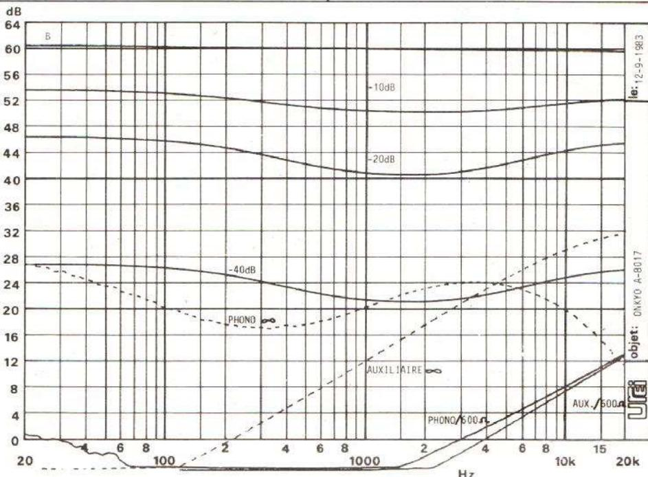
**Courbes B.** – Notons ici une correction physiologique d'amplitude limitée. La progression de cette correction se fait sur 20 dB de course de l'atténuateur de volume. En utilisant l'atténuateur de 20 dB, on réduira son influence pour les niveaux sonores usuels.
