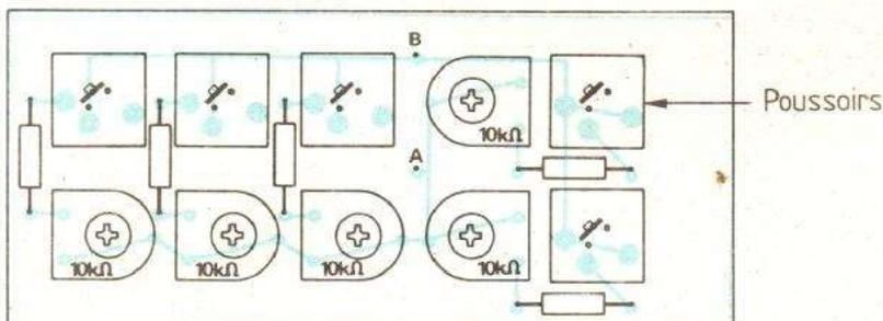
Fig. 5. — Poussoirs de l'émetteur, implantation des composants.
