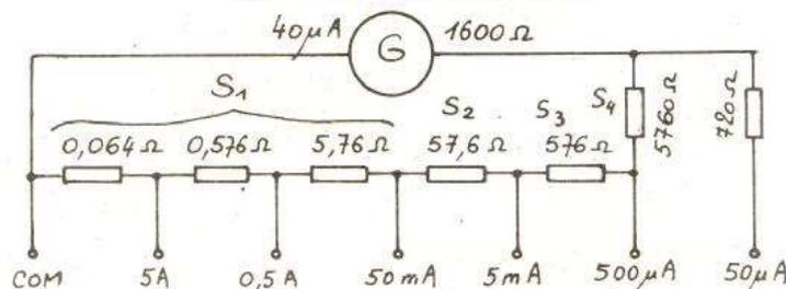
Fig. 2. - Shunts fractionnés.
