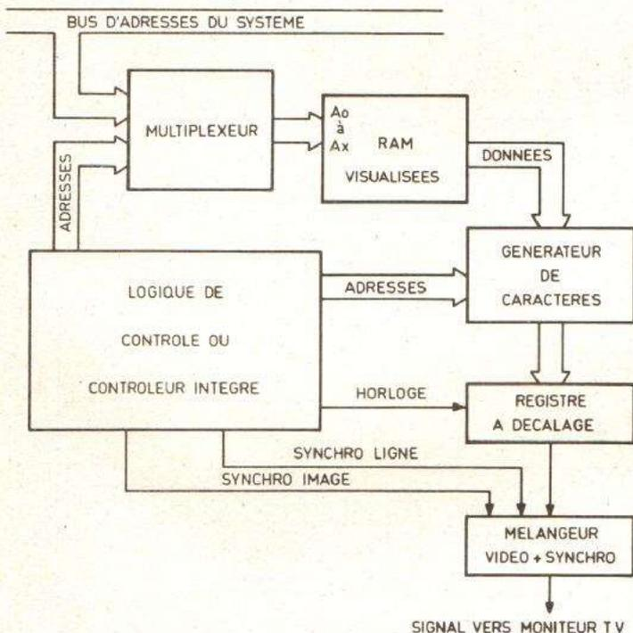
Fig. 4. - Synoptique d'un système de visualisation alphanumérique.
