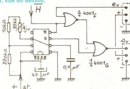
Fig. 5. — Schéma du complément SECURITEF (1 voie dessinée sur 4).
