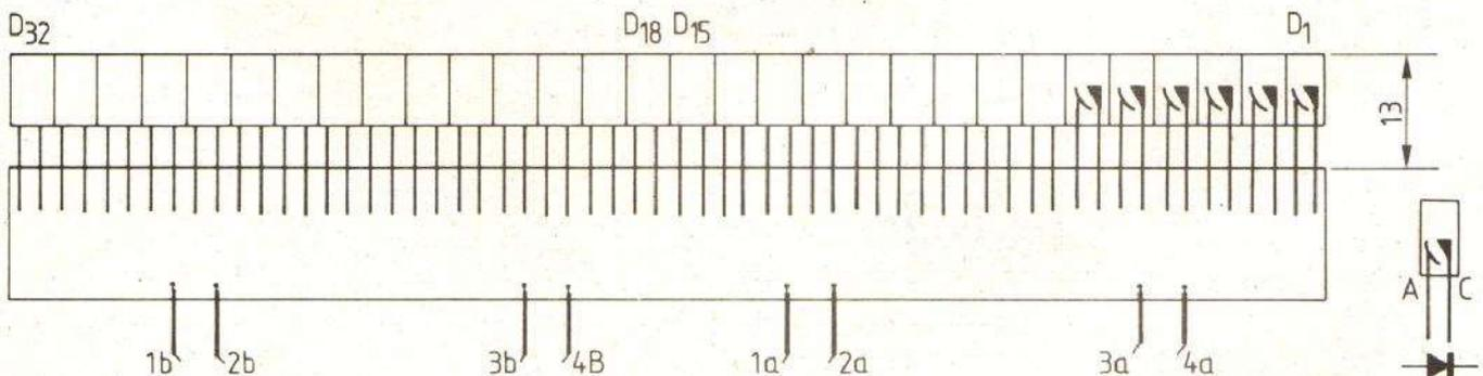
Fig. 16. - Montage des diodes et liaison des cathodes.
