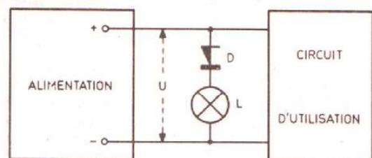
Fig. 2. — Détecteur de surtension utilisant une diode PNP.
