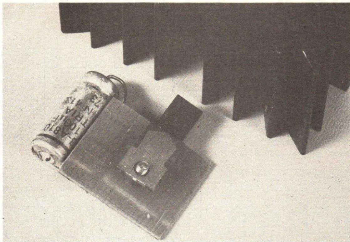
Photo 1. — Le circuit imprimé, vu côté époxy, avec le transistor de puissance. Au fond, le radiateur alutronic.
