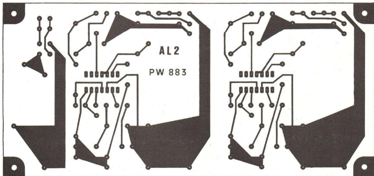
Fig. 5. - Le circuit imprimé à l'échelle 1/1. A réaliser de préférence en époxy de 15/10°.
