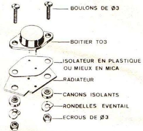
Fig. 6. - Rappel du principe de montage d'un transistor de puissance sur un radiateur avec les accessoires d'isolement.
