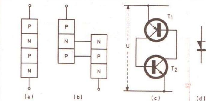
Fig. 1. — La diode PNP (a) peut être représentée scindée en deux (b), pour comprendre son fonctionnement (c). Sa représentation symbolique est donnée en (d).
