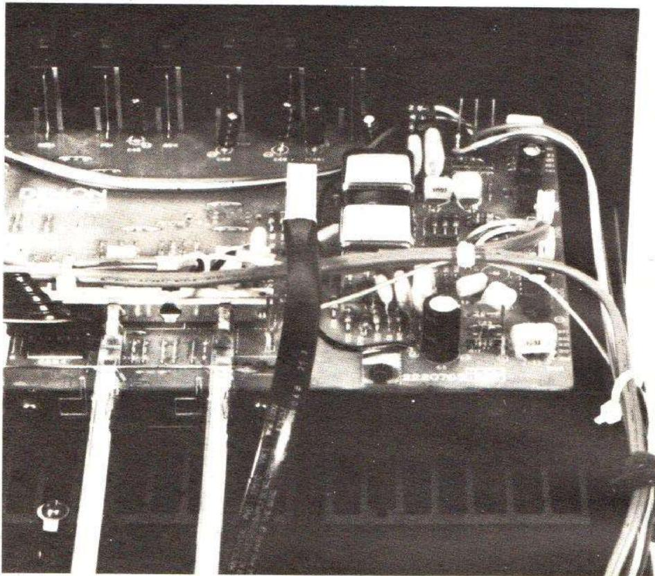
Au fond, les prises ; les commutateurs sont commandés soit par triacs, soit par flexibles.
