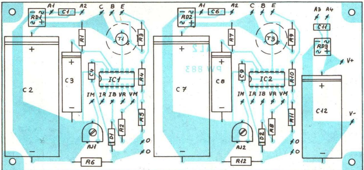
Fig. 6. - Implantation des composants sur le circuit imprimé. Il est préférable de coller les condensateurs C<sub>2</sub> et C<sub>7</sub> en raison de leur masse.
