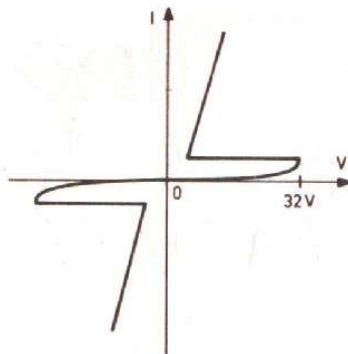
Fig. 18. - Courbe caractéristique d'un diac.
