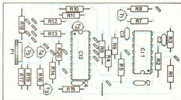
Fig. 24. - Câblage du module de commutation.
