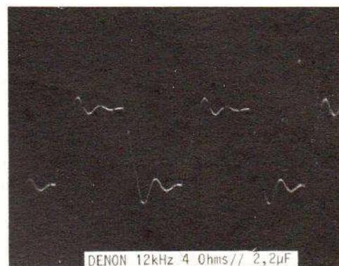
Photo B. — Réponse aux signaux carrés de l'amplificateur DENON sur charge capacitive. Notons ici un temps de montée relativement long et un accident au cours de la montée ou de la descente, la suroscillation est d'une amplitude réduite. La charge est ici constituée d'une résistance pure de 4 Ω en parallèle sur un condensateur de 2,2 μ.
