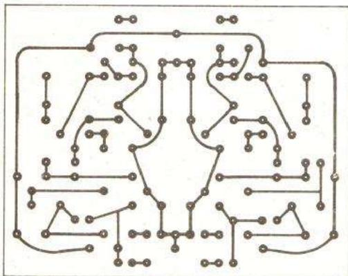
Fig. 26. — Circuit imprimé du filtre multiplex.
