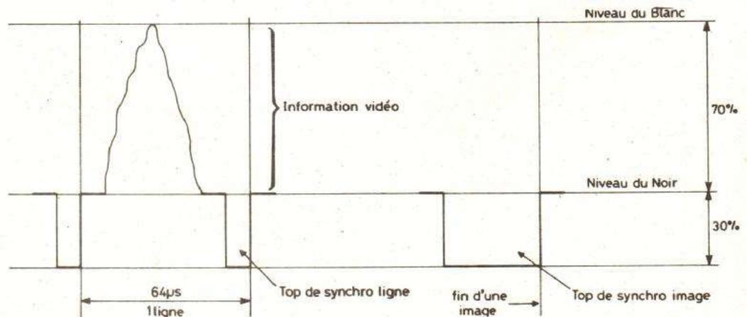
Fig. 3. — Aspect des éléments fondamentaux d'un signal vidéo.
