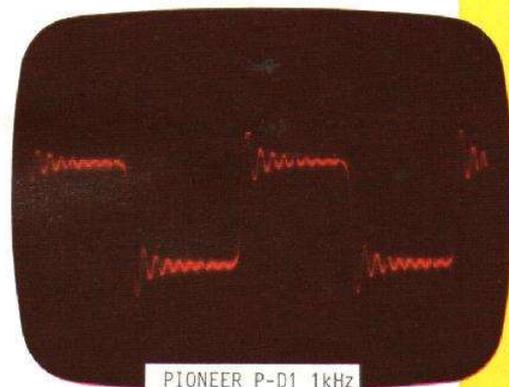
Photo 1. - Réponse du lecteur Pioneer P-D1 aux signaux carrés. La fréquence de ces signaux, de 1002 Hz est choisie pour éviter les interférences avec la fréquence d'échantillonnage. On notera ici le dépassement relatif dû à la suroscillation aux fronts de montée et de descente.
