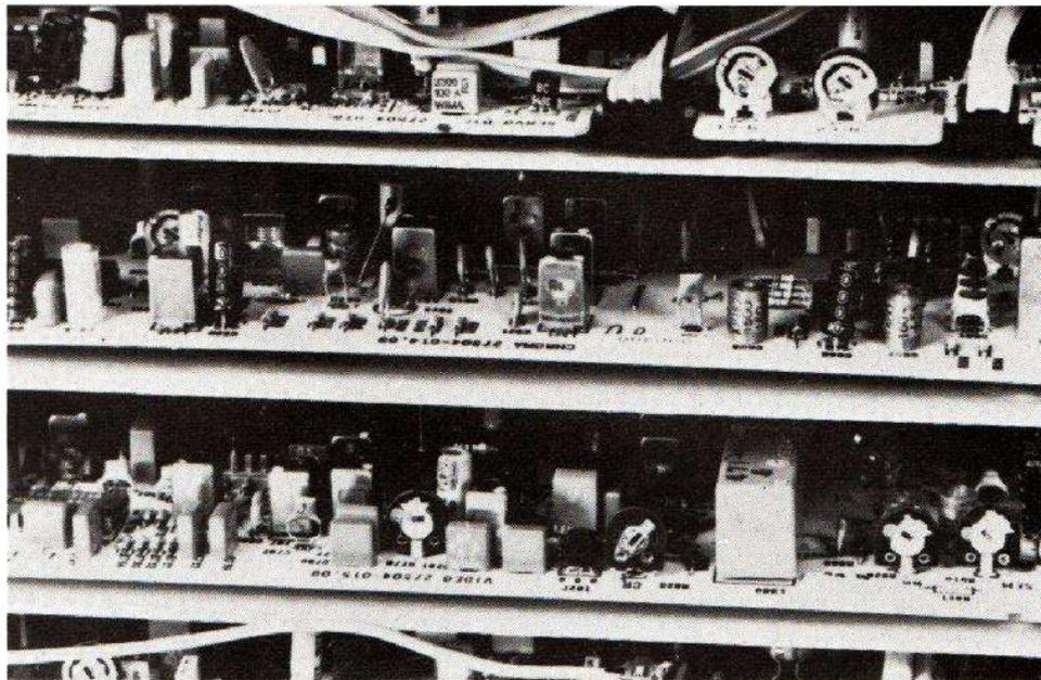
Trois des circuits imprimés du magnétoscope : c'est propre et bien agencé.
