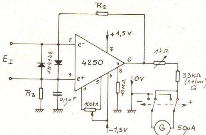
Fig. 5. - Schéma complet du mano-ampèremètre.
