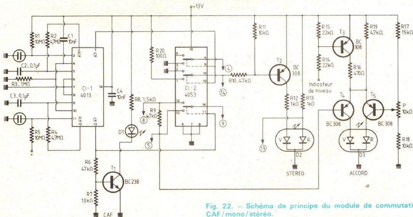
Fig. 22. - Schéma de principe du module de commutation CAF/mono/stéréo.
