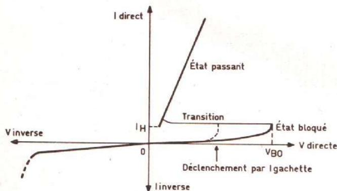
Fig. 17. - Courbe caractéristique d'un thyristor.
