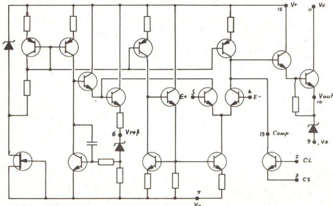
Fig. 1. - Les entrailles du circuit intégré µA 723.
