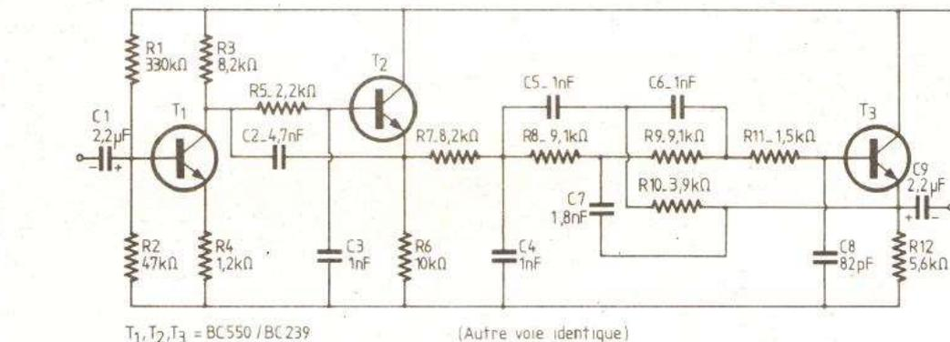
Fig. 25. — Schéma de principe de l'une des voies du module de filtrage multiplex.
