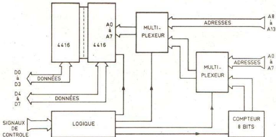
Fig. 2. - Synoptique de l'extension RAM à base de 4416.
