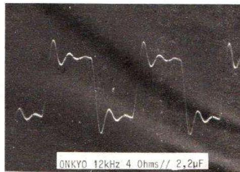
**Photo B.** – Réponse aux signaux carrés à 12 kHz sur charge capacitive de l'amplificateur Onkyo. On note une suroscillation. La charge de l'amplificateur est ici constituée d'un condensateur de 2,2 µF en parallèle sur une résistance pure (à couche) de 4 Ω.
