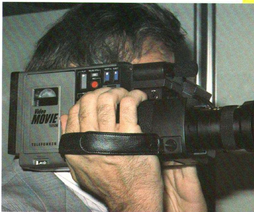
VHS-C se lit facilement sur tout magnétoscope VHS grâce à un adaptateur. La Vidéomovie, qui ne pèse que 1,9 kg – sans batterie – est la caméra avec magnétoscope incorporé la plus légère jamais présentée (on rapprochera ce chiffre des 2,48 kg de la Betamovie, poids également donné sans batteries).
