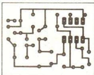
Fig. 2. — Le circuit imprimé émetteur.
