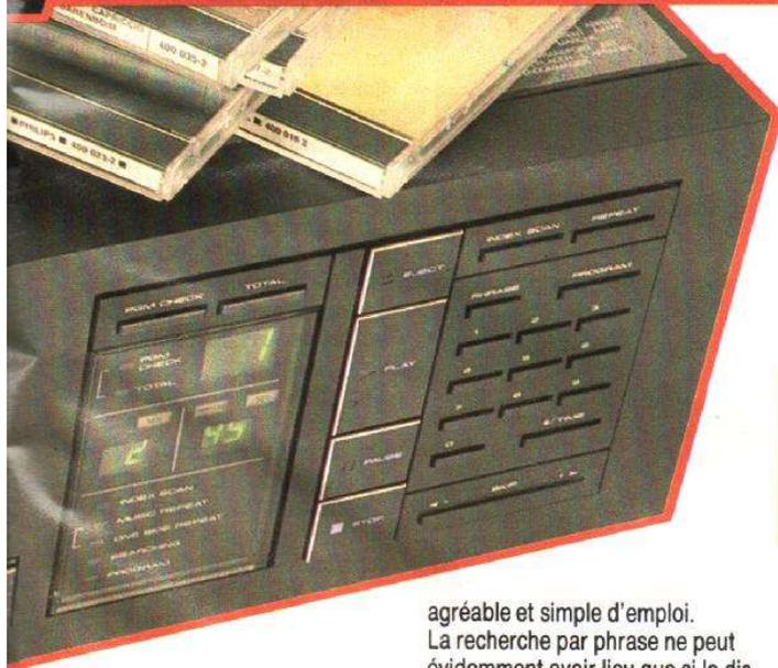
L'écoute directe au casque n'est pas possible puisque le constructeur n'a pas prévu de prise pour jack, une lacune que nous regretterons, compte tenu de la taille du lecteur. L'absence de réglage du niveau de sortie, empêchera les comparaisons instantanées entre le disque analogique (pas si mauvais que ça au fond) et le numérique. Cette comparaison demande, en effet, pour être valable une égalité de niveau de lecture.
