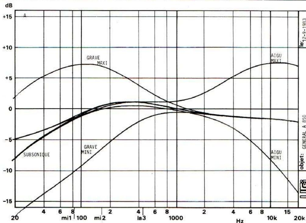
Courbes A. – Ces courbes ont été relevées sur l'entrée RIAA de l'amplificateur, comme pour les autres amplificateurs. Nous constatons ici une linéarité imparfaite de la chaîne d'amplification due à ce préamplificateur RIAA qui demanderait des composants de plus grande précision. La correction est d'une efficacité correcte, sans excès.
