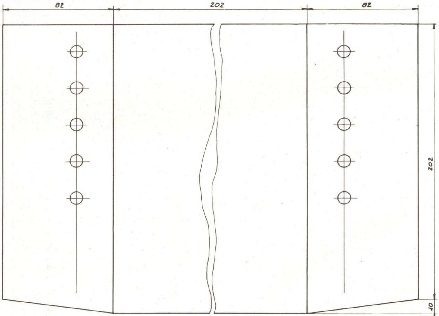
Fig. 8. — Le couvercle à réaliser en tôle d'alu de 10/10<sup>e</sup>, pliage vers l'arrière.
