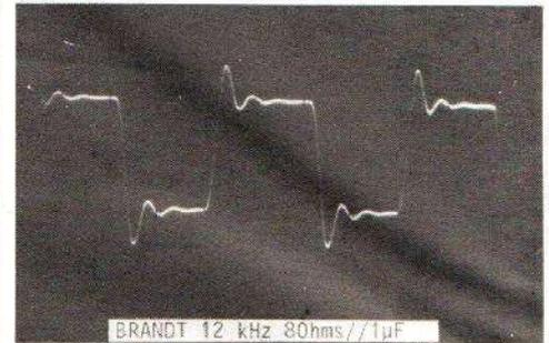
Réponse de l'amplificateur Brandt aux signaux carrés sur charge capacitive. La suroscillation s'amortit rapidement. Cet amplificateur ne supporte pas ces signaux carrés à forte puissance, son dispositif de sécurité coupe, les sorties. La charge est ici constituée d'une résistance pure de 8 Ohms en parallèle sur un condensateur de 1µF.
