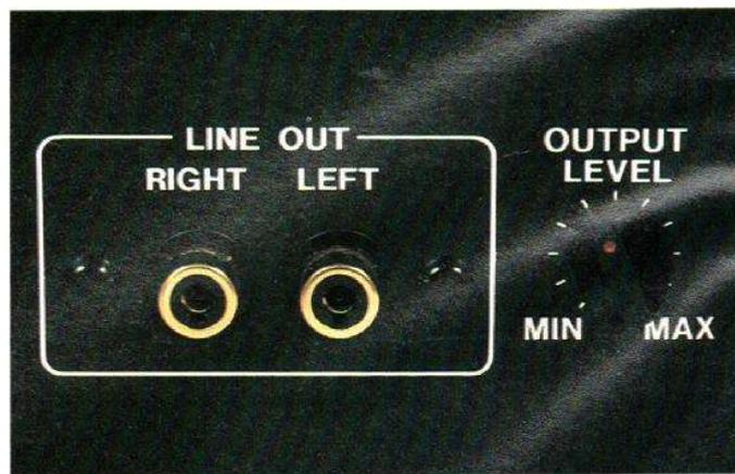
Photo 3. - Les prises arrière et le potentiomètre de niveau.
