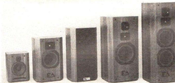
haut-parleurs Audax de la série HR. Tous ces haut-parleurs ont des bobines alu de faible inertie et des aimants puissants. Les médiums sont au « ferrofluid » assurant une meilleure tenue en puissance. Les tweeters sur tous les modèles sont du type à dôme. Côté filtre, des composants sélectionnés, avec des selfs à air pour le grave, permettent d'avoir une grande précision dans les
