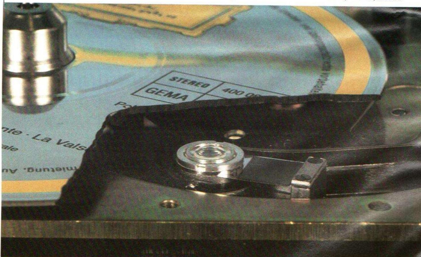
Photo A. — Le lecteur laser est monté sur deux lames de ressort.
