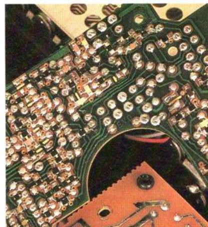
Photo C. - La technologie du lecteur : des composants soudés côté cuivre.
