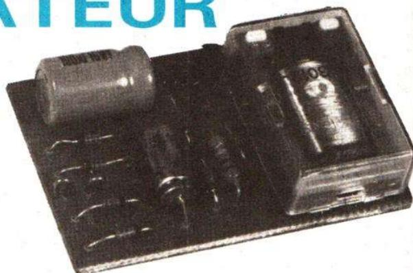
Le module de confort permet de remédier aux inconvénients des transitoires dus à l'établissement de la tension dans le préamplificateur. Ce module court-circuite la sortie du préamplificateur lorsque ce dernier est à l'arrêt, il
