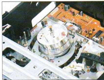
Un bac placé dans le bas du téléviseur reçoit la platine du magnétoscope, un modèle simple à deux têtes. Programmeur et alimentation sont communs au du téléviseur.
