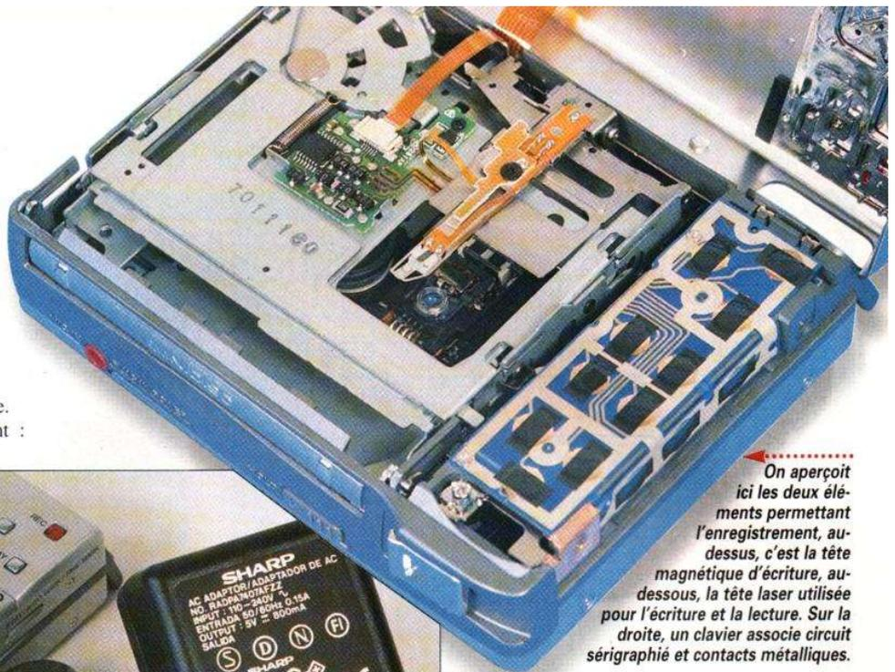
On aperçoit ici les deux éléments permettant l'enregistrement, au-dessus, c'est la tête magnétique d'écriture, au-dessous, la tête laser utilisée pour l'écriture et la lecture. Sur la droite, un clavier associé circuit sérigraphié et contacts métalliques.
