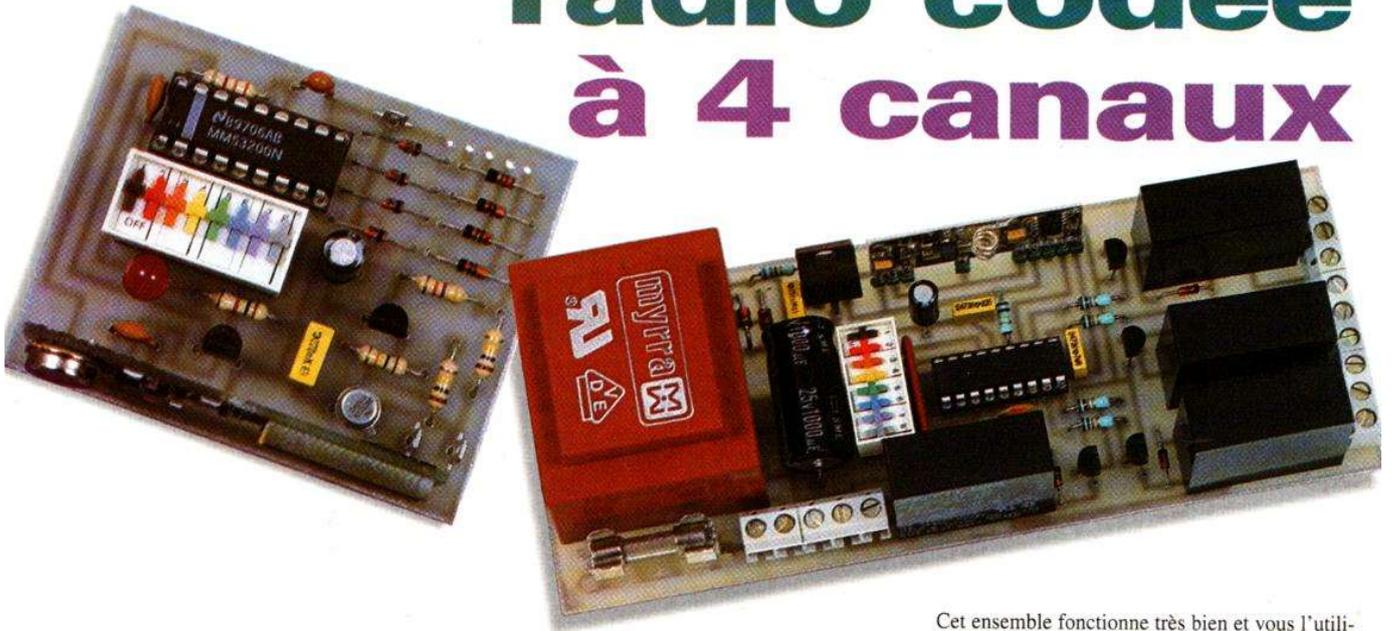
La réalisation de télécommandes radio est aujourd'hui grandement facilitée par la commercialisation sous forme de modules de leur partie la plus délicate, à savoir les étages d'émission et de réception. Qui plus est, ces modules fonctionnent sur la fréquence normalisée au niveau européen de 433,92 MHz et permettent ainsi de constituer des appareils parfaitement en règle vis à vis des diverses législations en vigueur.
