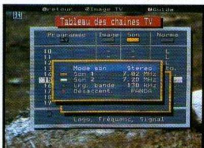
Ici, nous avons appelé le tableau des chaînes et demandé le réglage du son, ce dernier demande deux sous-menus. Dans le cas des réglages sur l'image, il ne restera que le sous-menu, le tableau disparaît pour permettre de voir une plus grande surface de l'image.
