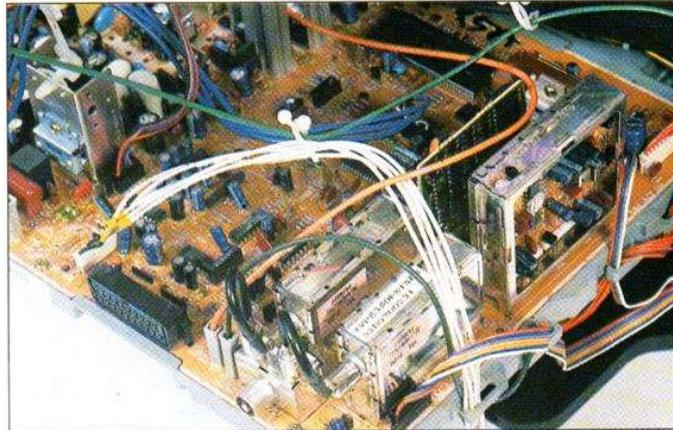
Les deux tuners, celui du téléviseur et celui du magnétoscope sont reliés par un coupleur à l'antenne. Bien sûr, ils se programment en même temps mais pourront être accordés séparément.
