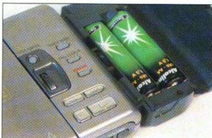
Sur le côté de l'appareil, la mise en place du boîtier à piles prolonge la durée d'utilisation. Au premier plan, dans la surface grise, plus sombre, une molette permet la recherche des plages, une pression lui donne alors accès.
