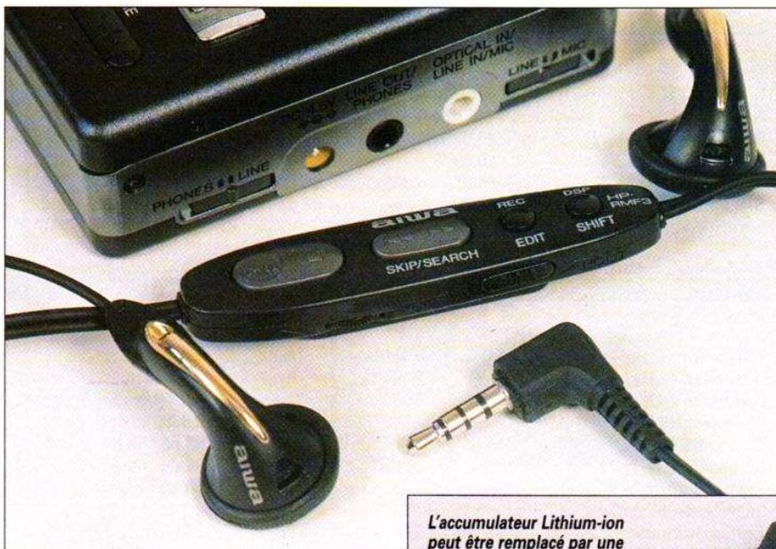
Le casque à télécommande se branche par une prise à quatre contacts qui sera reconnue par l'appareil. Notez les commutateurs de part et d'autre des prises d'entrée et de sortie.
