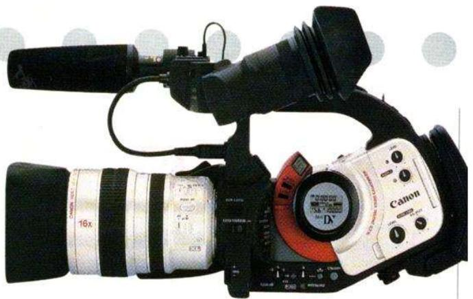
EF de la gamme EOS. Sans oublier la technique du Tri-CCD à décalage de pixels qui accroît le niveau de reproduction des couleurs et la sensibilité. Côté audio, le XL-1 offre les avantages du son PCM en 12 ou 16 bits avec la fonction mixage dès le tournage.
