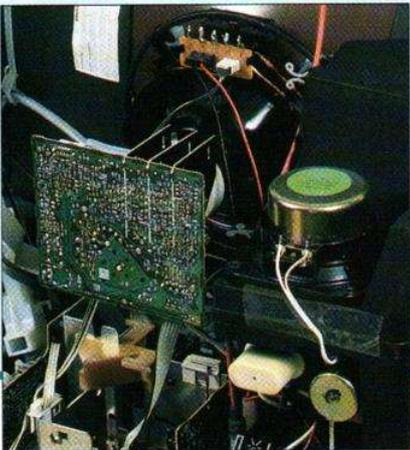
Sur la droite, Philips installe une enceinte bass-reflex, le haut-parleur externe permet de réduire la taille de l'enceinte, ses formes complexes sont adaptées au volume du téléviseur.
