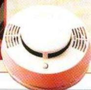
en partie vers une photodiode réceptrice qui normalement ne reçoit rien. Dès le début de l'incendie et les premiers dégagements de fumée, l'alarme du détecteur retentit (85 dB à 3 m). Une diode rouge, témoin de la bonne alimentation du système (pile 9 V). En cas d'incendie, ce clignotement s'accélère.
