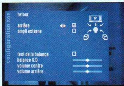
Réglage des paramètres Dolby prologic. Le réglage de retard pour les voies arrière n'est pas pris en compte.
