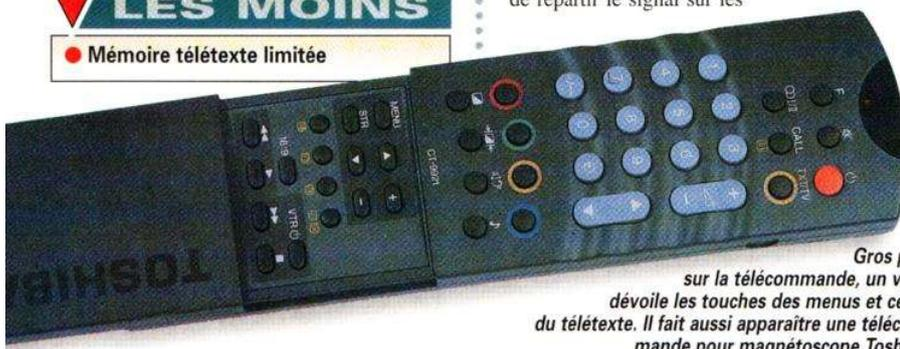
Gros plan sur la télécommande, un volet dévoile les touches des menus et celles du télétexte. Il fait aussi apparaître une télécommande pour magnéscope Toshiba.
