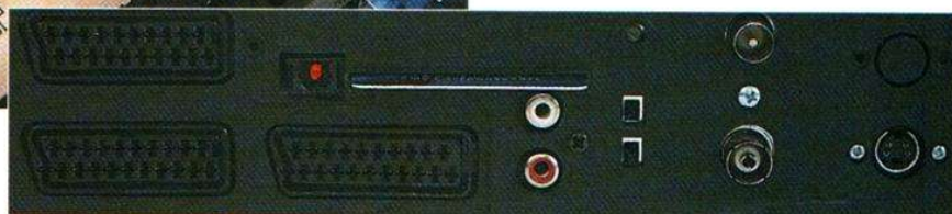
La face arrière supporte les trois prises Scart, c'est aussi ici que l'on introduit la carte DMX, la modulation est disponible en numérique optique. Une prise Mini-Din reçoit ou envoie des données, heure, programmation et autres...
