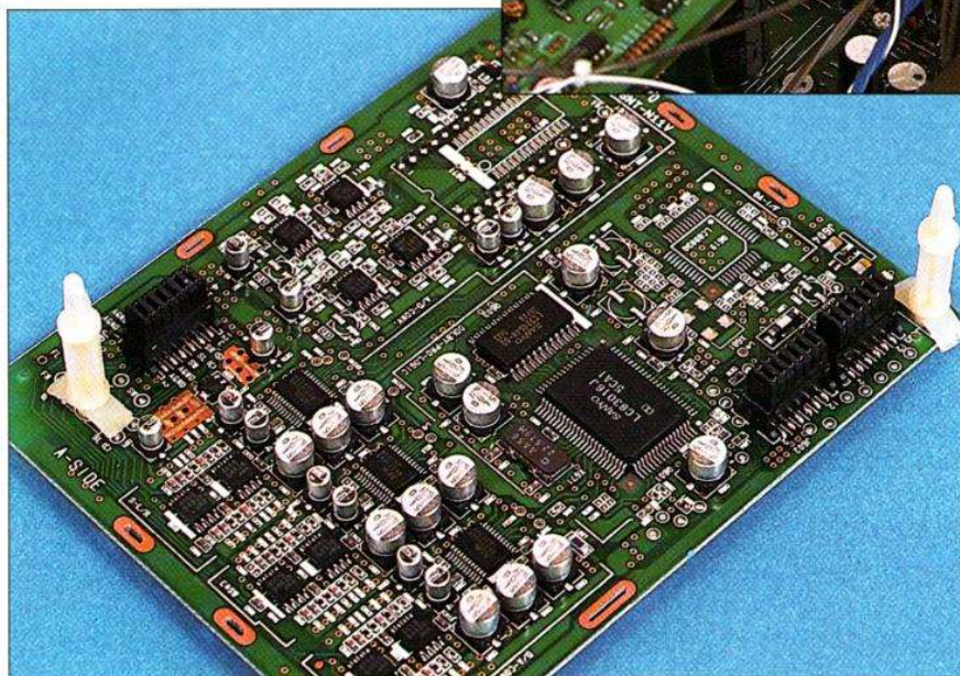
Le circuit imprimé de traitement Dolby Pro Logic /THX travaille en numérique. Au premier plan, les convertisseurs numériques-analogiques, derrière, le circuit Dolby Pro-Logic, tout au fond se trouve le convertisseur d'entrée, il est placé sur l'autre face du circuit.
