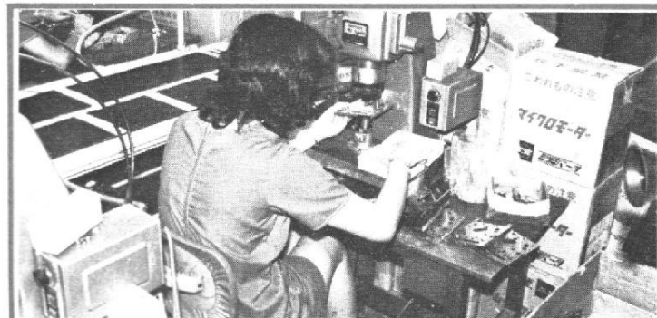
Photo A. - Machine à riveter pour le montage des platines de magnétophone.
