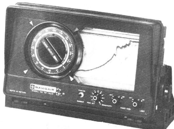
Photo 4. - Le sondeur NF-160 est un appareil mixte à éclats néon et enregistreur. Il permet de mesurer, avec ses 4 gammes, une profondeur atteignant 160 mètres. (Cliché Navigair).
