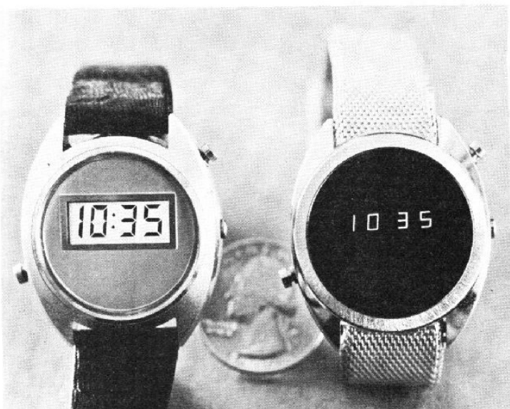
Photo 8. - Deux types d'affichage numérique : à diodes électroluminescentes et à cristaux liquides. (cliché Hughes Aircraft Co).
