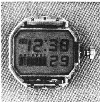
c) Dans la classe des montres digitales, voici celles à cristaux liquides : la montre Citizen, vue arrière avec et sans capot, et vue avant...
