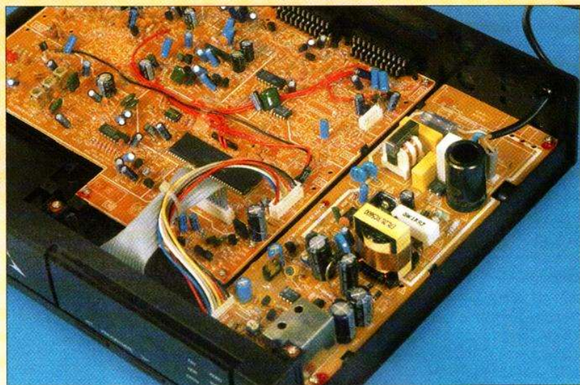
Le récepteur utilise une méthode de fabrication traditionnelle. L'alimentation est à découpage et non blindée, le circuit imprimé de base peut recevoir d'autres composants
