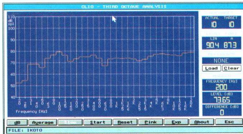
Relevé en 1/3 octave de la réponse en fréquence. L'aigu se situe 3 dB au dessus de la moyenne. Un creux à 600 Hz se retrouvera en mesure MLS (Waterfall).
