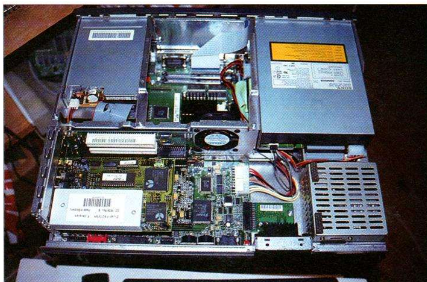
Vue plongeante sur un véritable objet du futur : en haut à gauche, le lecteur de disquette, et à droite (avec étiquette jaune), le lecteur de CD Rom. Derrière le ventilateur, le Pentium, microprocesseur cadencé à 75 MHz. En bas à gauche, les cartes (son, vidéo) et les emplacements pour cartes additionnelles. A droite, l'alimentation, particulièrement compacte, pour un ordinateur.
