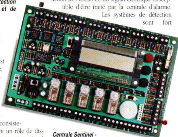
Centrale Sentinel - Cette centrale programmable ajoute, aux fonctions strictement de protection, des fonctions domestiques telles que : horloge en temps réel, programmation de timers, régulation de température, etc.
