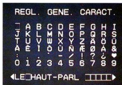
Un générateur de caractères intégré permet la composition de titres personnalisés en plus de ceux de la mémoire du camescope.
